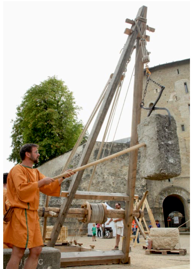
Absenken eines 400 kg schweren Quaders mit der Steinzange: Mithilfe eines Holzes wird der Steinblock geführt, um ein unkontrolliertes Ausschwingen zu vermeiden.
