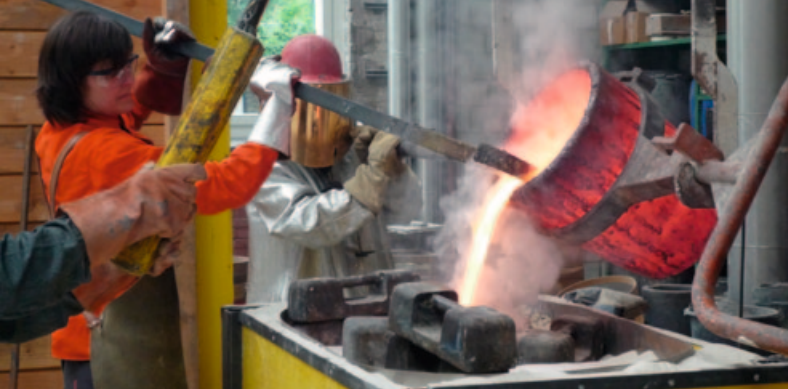
In den Hohlraum wird flüssige, 1100–1200° Celsius heiße Bronze gegossen. Foto Markus Schaub
