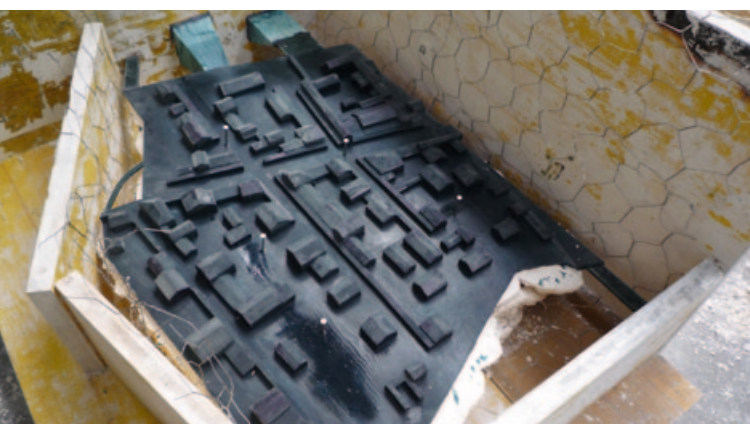
Arbeiten der Firma Visual-Data-Systems in Arlesheim. Links: Zwischenstand beim Absaugen einer gedruckten 3D-Platte mit Quartieren der Oberstadt. Rechts: Zusammenpassende Platten des Stadtzentrums mit Forum und Theater. Blick von Norden.
