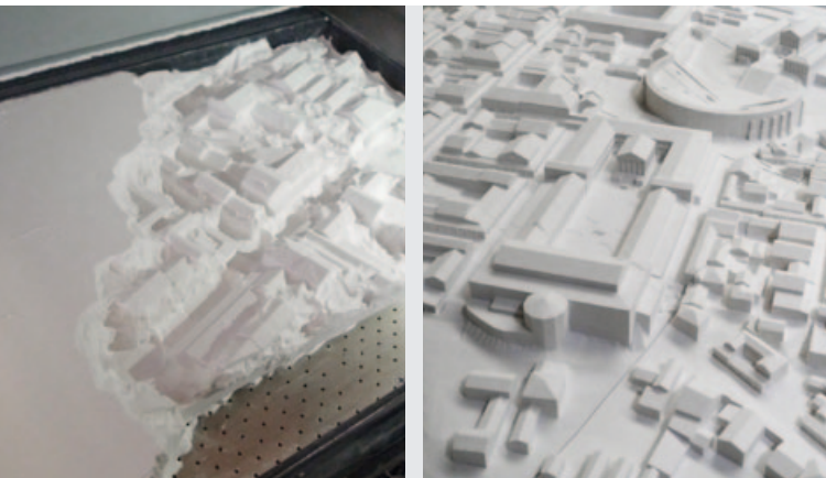
Arbeiten der Firma Visual-Data-Systems in Arlesheim. Links: Zwischenstand beim Absaugen einer gedruckten 3D-Platte mit Quartieren der Oberstadt. Rechts: Zusammenpassende Platten des Stadtzentrums mit Forum und Theater. Blick von Norden.
