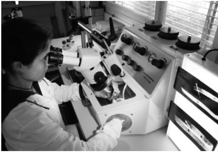
Das Feinstrahlgerät ist häufig im Einsatz. Sehr feinkörniges Strahlmittel wird mit Luftdruck auf die Objektoberfläche geblasen. Damit kann Nina Fernández fast ohne Druckeinwirkung harte Auflagerungen von der teils sehr empfindlichen Oberfläche des Eisenobjekts abnehmen. (Foto Susanne Schenker)
