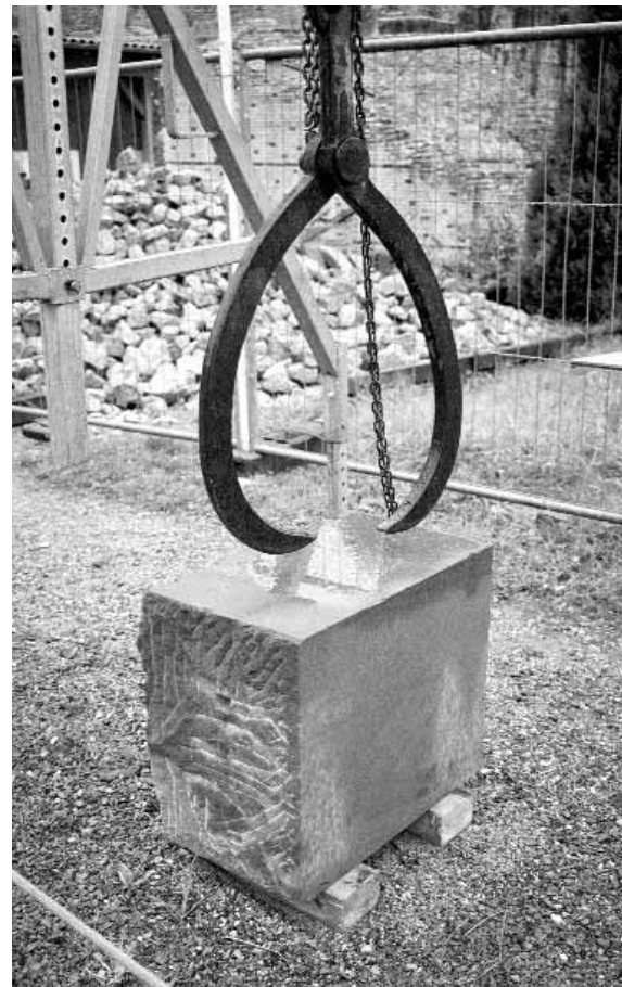
Hebezange aus Eisen, bereit zum Einsatz. Man beachte die seitlichen Greifflächen an dem zum Heben vorbereiteten Sandsteinquader. (Foto Ursi Schild)
