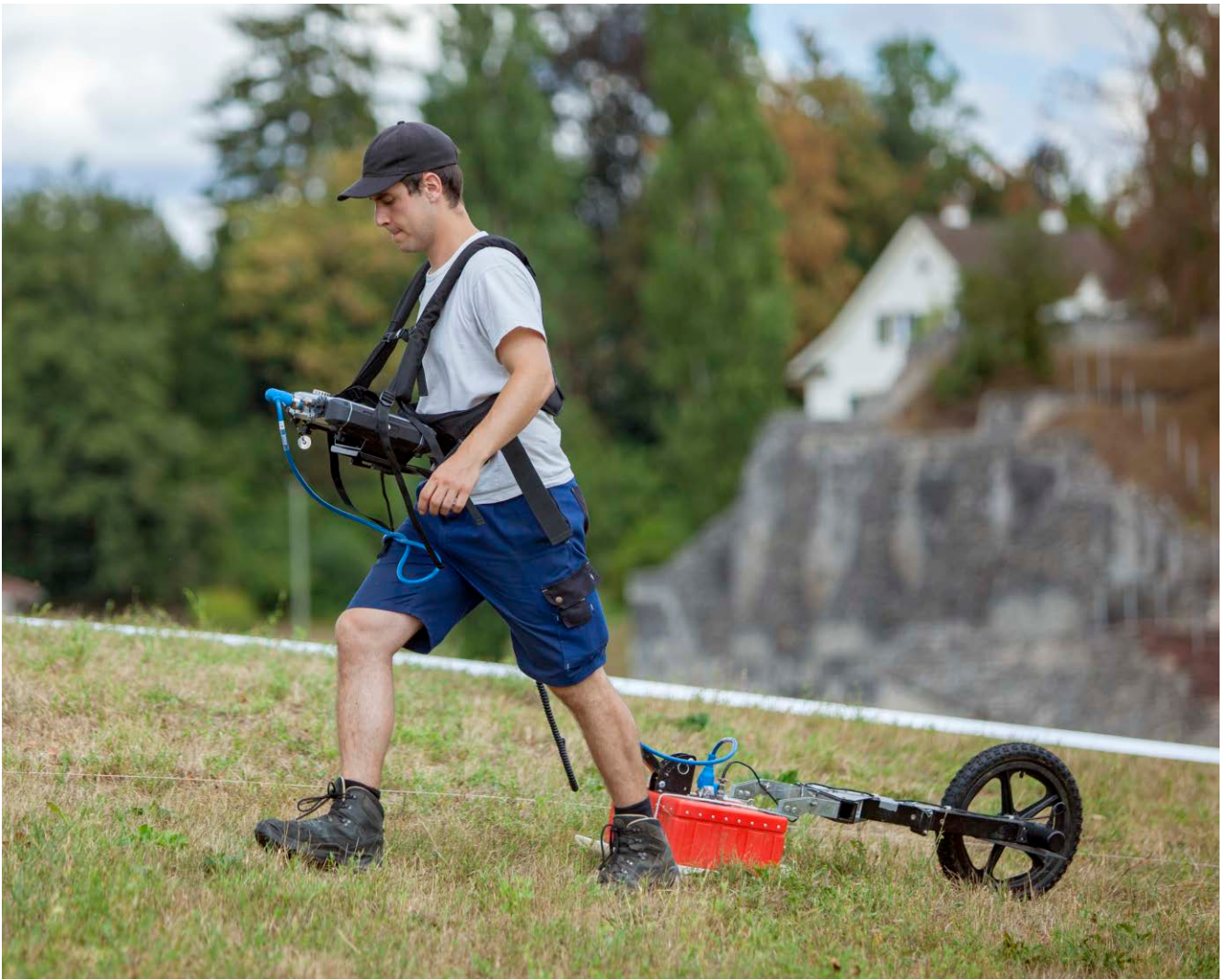
Abschreiten der Messfläche mit der Radarantenne. Mit einer Antenne (rotes Gerät) wird auf einer Breite von 50 cm gemessen. Foto Susanne Schenker
