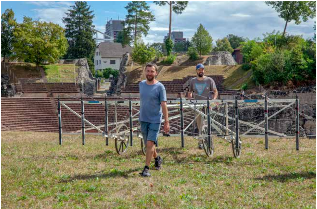
Abb. 4: Das Magnetometer der Universität Brno mit Peter Milo und Tomáš Tencer im Einsatz auf dem Schönbühl. Mit zehn Messfühlern wird das Magnetfeld auf einer Breite von 5 m gleichzeitig gemessen.
