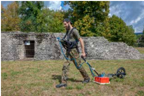
Abb. 5: Andreas Krekla (Universität Bamberg) beim Abschreiten der Messfläche auf Schönbühl mit dem Bodenradarmessgerät.
