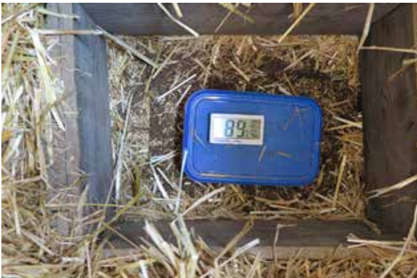
Abb. 22: Kaiseraugst AG, Experiment Schacht Wacht (Ereignis 2016.002). Datenlogger zur Messung von Temperatur und Luftfeuchtigkeit wurden in den Schacht gesetzt.
