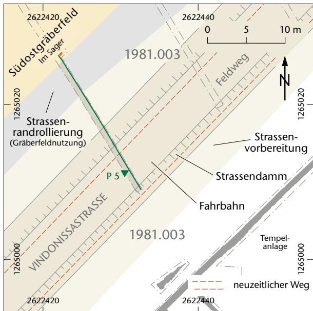
Abb. 19: Kaiseraugst AG. Detail des Strassenaufschlusses der Grabung 1981.003 «Neubau Tennisplätze, Im Sager-Liebrüti». M. 1:500.
