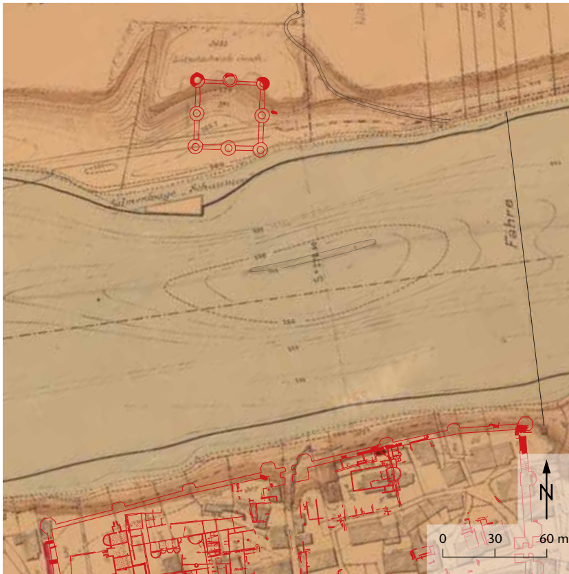
Abb. 20: Kaiseraugst AG/Wyhlen (D). Plan mit Höhenkurven von 1903 aus der Zeit vor dem Bau des Augster Kraftwerks. Die Senke im Rheinbett ist als Rinne eingezeichnet. Eingetragen sind die römischen Grundrissreste. Beachte die «Schaumer» genannte Salmenwaage vor dem rechten Rheinufer. M. 1:3000.
