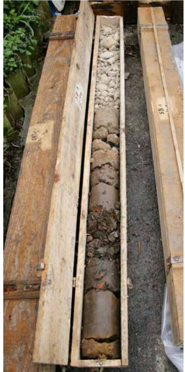
Abb. 11: Augst BL, Hauptstrasse Leitungssondierungen (Grabung 2012.053). Der Bohrkern aus der Bohrung an der Böschung des Violenbachs. Oben ist unten. Die dicke Lehmschicht ist wahrscheinlich neuzeitlich und stammt von den ursprünglich hier vorhandenen Bauten des Augster Brückenkopfs gegen Kaiseraugst.
