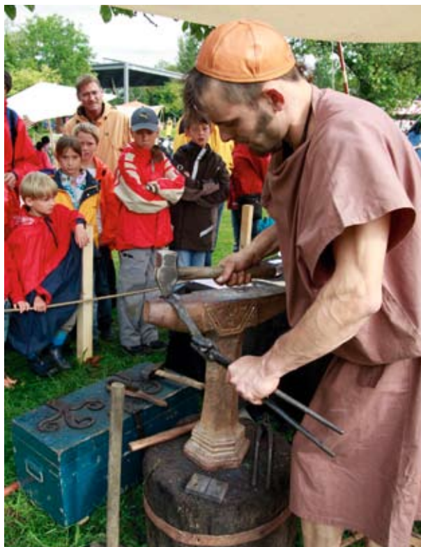
Abb. 27: Augusta Raurica, Römerfest 2010. Reto Zürcher als «römischer» Schmied bearbeitet einen Eisenstab, der – profiliert und feuerverschweisst – als Verbindungsmuffe zwischen zwei Teucheln (hölzerne Wasserleitungsröhren) eingeschlagen werden soll.
