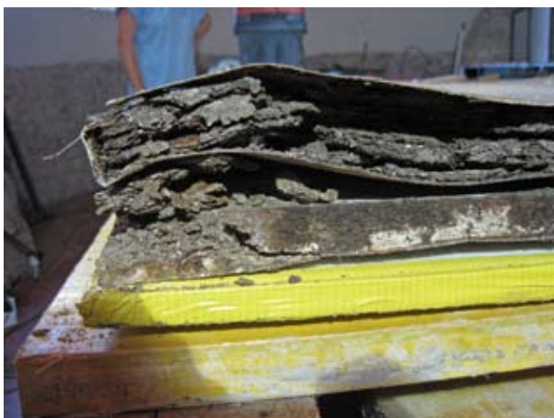
Abb. 63: Augst BL, Curia/Mosaikenausstellung. Ein erster Blick nach Abnahme des Mosaiks «Palazzo IV» auf die Stirnseite: Die alte Trägerplatte aus Novopan ist völlig zerstört.
