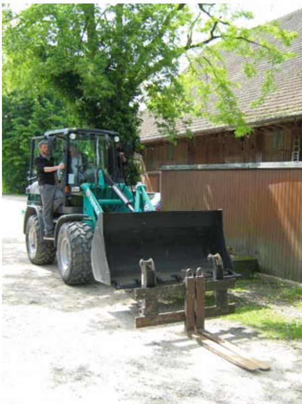
Abb. 84: Der neue Pneulader Terex des Technischen Dienstes. Das Vielzweckgerät muss transportieren, ziehen und heben können – beim Transport römischer Architekturstücke, beim Rangieren von beladenen Paletten oder beim Transport von Requisiten vom Obergeschoss einer Scheune ins Gelände des Römerfests.
