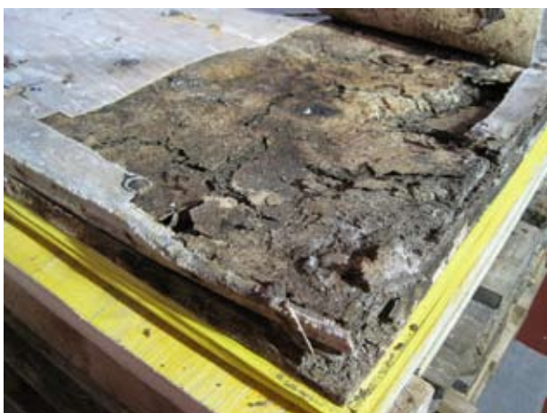
Abb. 64: Augst BL, Curia/Mosaikenausstellung. Die Trägerplatte des Mosaiks «Palazzo IV» war im unteren Bereich völlig verfault, stark von Algen und Schimmelpilzen befallen und damit in extrem schlechtem, übelriechendem Zustand.
