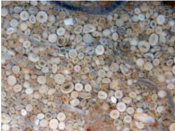
Abb. 11: Hauptrogenstein mit den typischen Ooiden. Oben natürlich gebrochen (Ausschnitt ca. 34 mm breit); unten angeschliffen und poliert (Ausschnitt ca. 13 mm breit).
