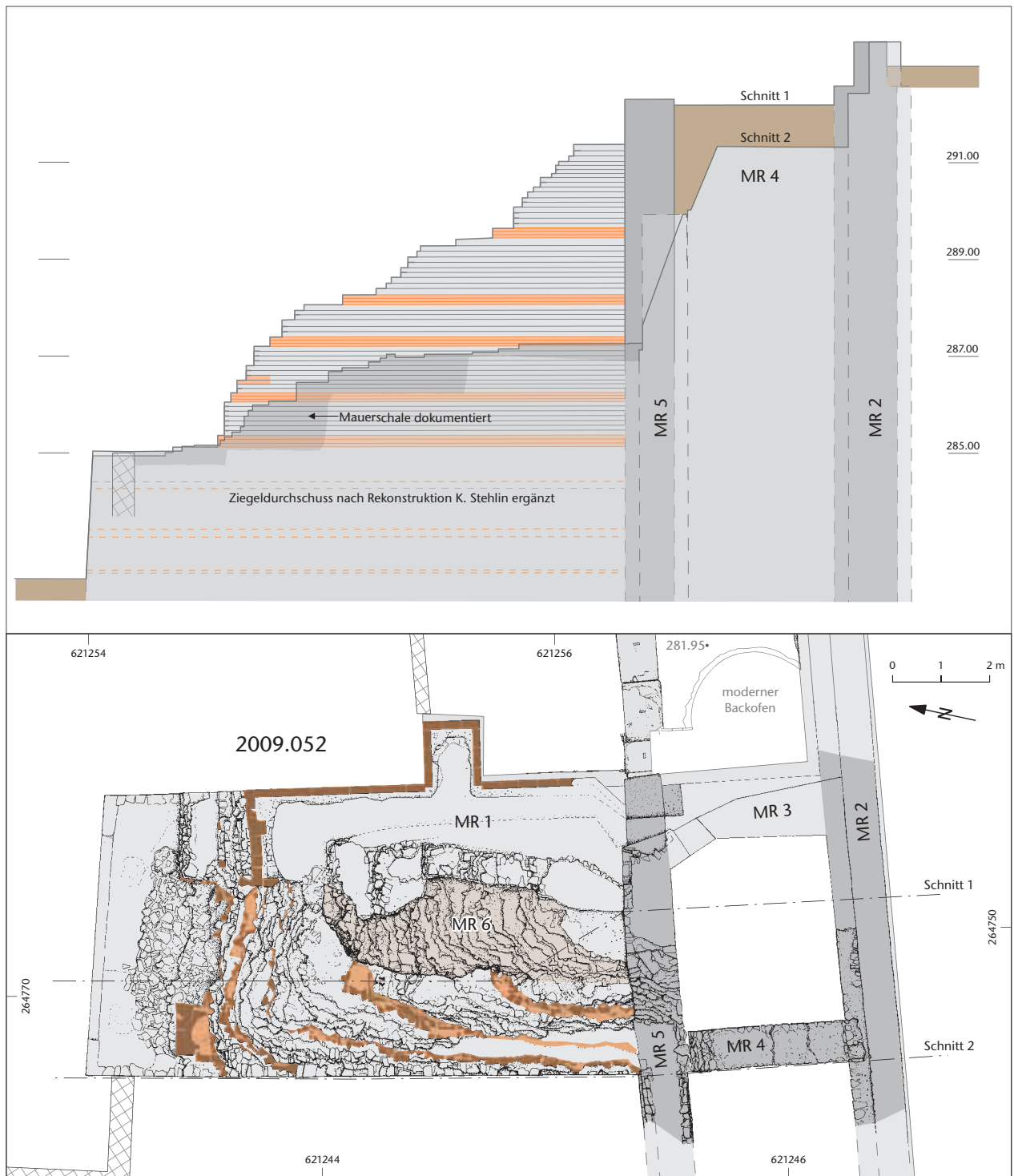
Abb. 15: Augst BL, Stützpfeiler Schönbühl (Grabung 2009.052). Aufsicht und Schnittebenen durch den Stützpfeiler. Die Ziegeldurchschüsse im Mauerwerk sind dunkelrot/orange hervorgehoben. M. 1:125.
