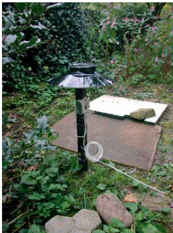
Abb. 5: Experimentelle Lös- und Sumpfanordnung für Kalkmörtel mit Temperaturmesssonden des Autors in Gelterkinden/BL im Jahr 2003.
