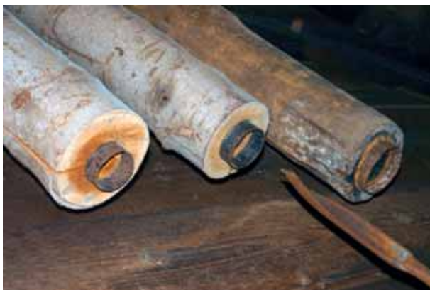
Abb. 39: Augst-Obermühle, Grabung 2006–2007.051. Verbindungstechnik für Wasserleitungsrohre (Teuchel) aus Holz (oben: schematische Darstellung; unten: frühneuzeitliche Beispiele. Vor dem mittleren Teuchelrohr liegt ein eiserner Teuchelbohrer).
