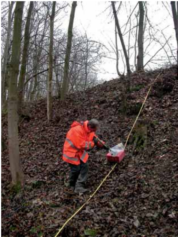
Abb. 13: Augst BL, Prospektion Insula 27 (Aktennummer 2007.106). Georadarprospektion unter erschwerten Bedingungen eines dicht mit Bäumen bestockten Steilhangs. Jörg Leckebusch führt das Messgerät entlang eines Messbandes.
