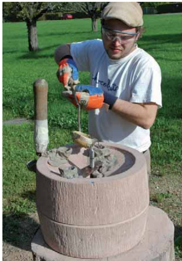
Abb. 7: Zivildiensteinsatz für einen guten Zweck: Mario Völlmin ist gelernter Steinmetz und hat bei seinem Einsatz in Augusta Raurica u. a. eine römische Steinmühle kopiert. Im Bild vergiesst der Steinmetz in antiker Technik die eiserne Achsführung mit flüssigem Blei im Stein des «Oberläufers» der Handmühle.
