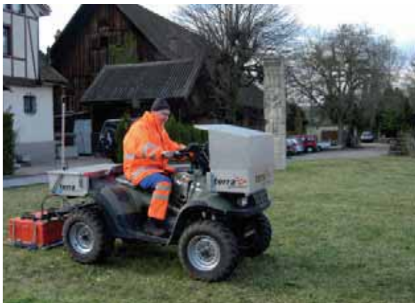
Abb. 39: Augst, Augusta Raurica. Der mit Hightech vollgepackte Kleintraktor der Firma Terra-Vermessungen aus Zürich wird in der geophysikalischen Prospektion von archäologischen Fundstätten eingesetzt. Das computerunterstützte Gefährt registriert seine Position laufend automatisch und kann sowohl Georadar-, Geoelektri- wie auch Geomagnetikmessungen durchführen. Auf der «Rossweid» in der Augster Insula 10 wurden so viele Details der römischen Bebauungsstruktur ermittelt (2006.104).
