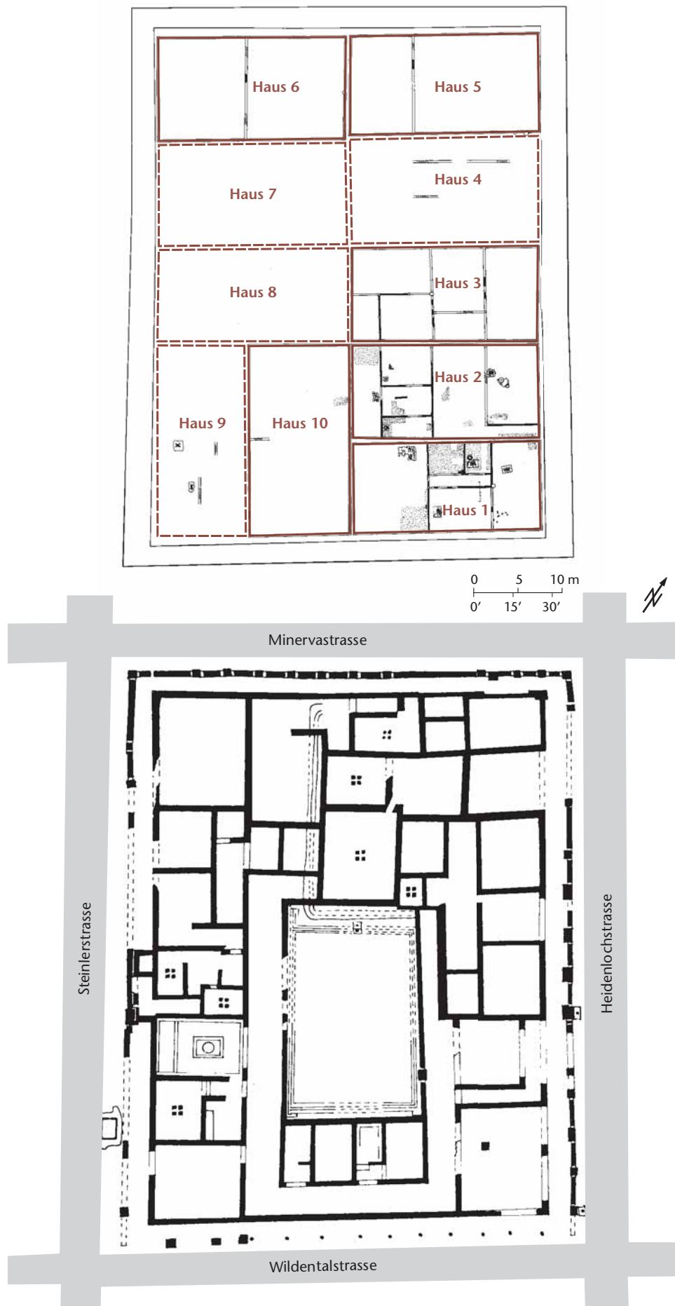
Abb. 22: Augst BL, Insula 30. Grundrissplan der Holzbauten. Das später mit einer domus (unten) überbaute Areal war ursprünglich in zwanzig quadratische Module à 38' \times 38' unterteilt. Die einzelnen Parzellen bestanden jeweils aus zwei Modulen ( 76' \times 38' bzw. 22,80 \text{ m} \times 11,40 \text{ m} ). Die einzelnen Hauseinheiten waren demzufolge etwa 260 \text{ m}^2 gross (ohne Portikusanteil). M. 1:600.
