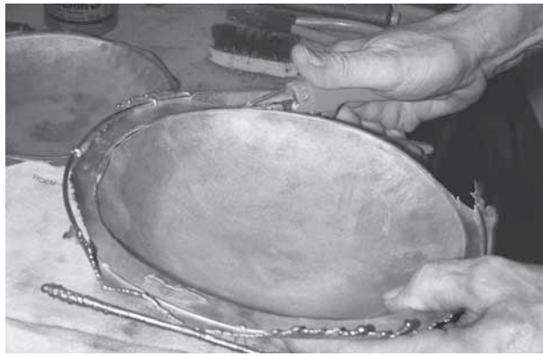
Abb. 55: Kaiseraugst, Augusta Raurica, Silberschatz. Der im Galvanobad gefertigte Kupferhohlring einer Kalottenschen-Kopie wird zugeschnitten (Bild), bevor er mit dem Galvanoteil der Schalen-Unterseite verlötet, poliert und anschliessend versilbert wird (Abb. 56).
