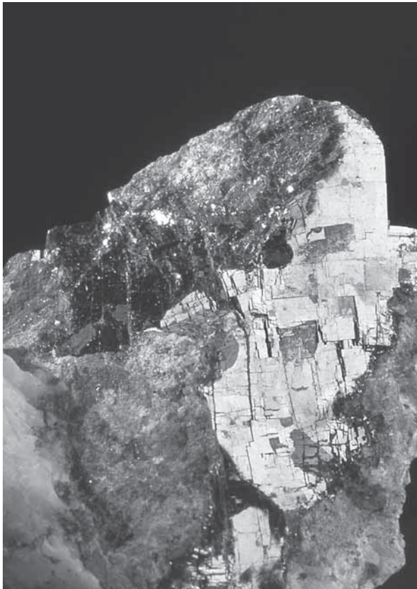
Abb. 2: Bleiglanz. Mehrere Erzminerale können für die Bleigewinnung in Frage kommen, das jedoch wichtigste und in historischer Zeit auch am häufigsten abgebaute Erz ist der Bleiglanz (PbS), der mit 87% Bleigehalt auch eines der reichsten Bleierze ist.
