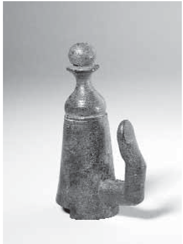
Abb. 23: Augst, alter Museumsbestand. Der zierliche bronzene Gurthalter diente zur Wagenkastenaufhängung mit Hilfe einer starken Lederschlaufe an einem kleinen Wagen. Er ist 98 mm hoch und hat unten eine runde Tülle von 37 mm Aussendurchmesser (vgl. Anm. 34). Das obere, verzierte Drittel ist auf der Drehbank abgedreht, der fingerförmige Haken hohl mitgegossen. Für die Rekonstruktion auf Abb. 25 diente dieses Stück als Vorbild. M. 1:1.
