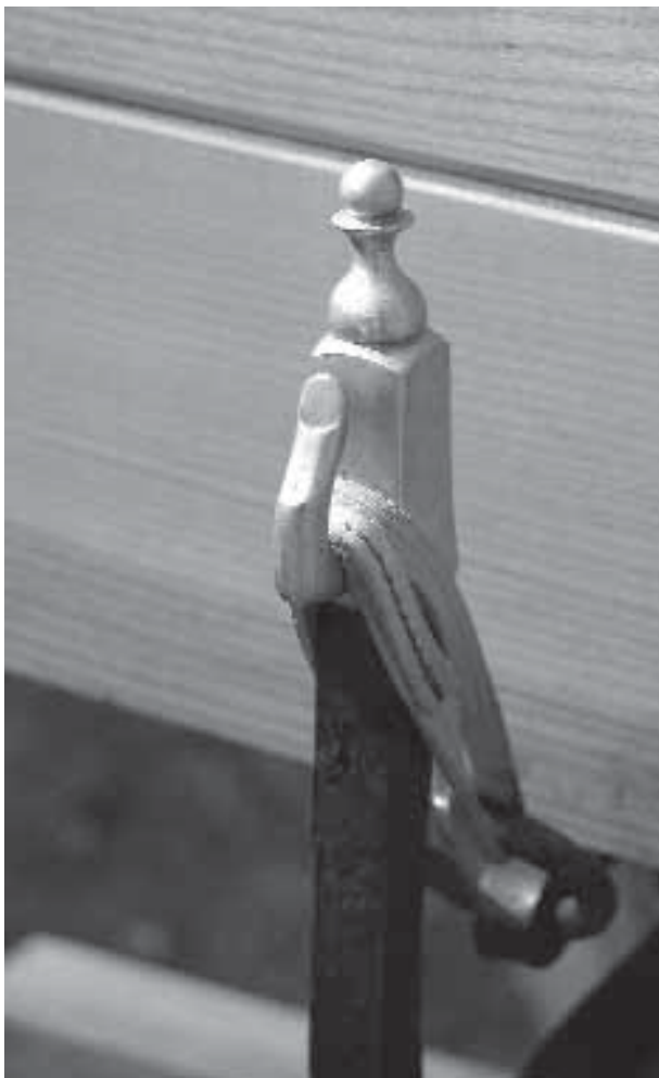
Abb. 14: Eiserner Kipf mit dem von Markus Binggeli gegossenen bronzenen Gurthalter am Augster Wagen.
