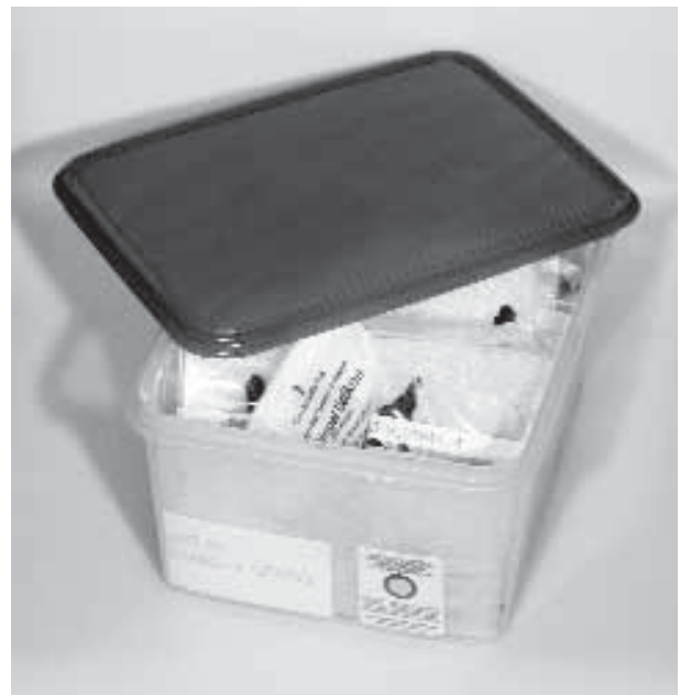
Abb. 39: Neukonzeption für die Verpackung von Metallobjekten in den Augster Funddepots: Die Objekte werden einzeln in «Minigrip»-Plastiktütchen gelegt, in Serien in PE-Dosen verpackt und dort mit Silikagel und Feuchtigkeits-Indikatorkarte (vorne an der Stirnwand) zur Kontrolle der Lagerungsklimas ergänzt.
