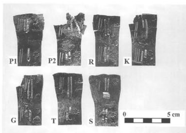
Abb. 16 Die Testlegierungen P1, P2, R, K, G, T und S (Rückseiten von Abb. 11) mit Gravierversuchen mit dem Stichel (jeweils links auf den Plättchen), Schnittversuchen mit Hammer und Meissel (Mitte) und gepunzt (rechts). Zum Vergleich wurden die Bearbeitungen sowohl auf dem weichen, ausgeglühten und abgeschreckten Teil (jeweils unten) als auch auf dem durch Kaltschmieden gehärteten Teil (oben) durchgeführt. M. 1:2,5.
