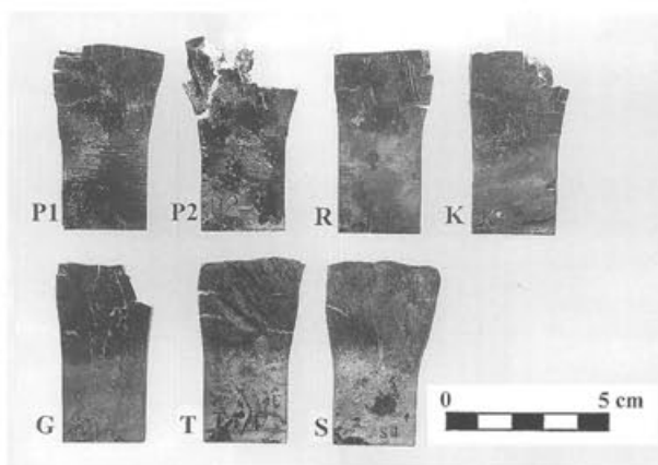
Abb. 11 Die Testlegierungen P1 , P2 , R , K , G , T und S nach dem Kaltschmieden. M. 1:2,5.
