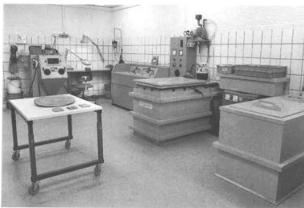
Abb. 25 Konservierungen und Ruinendienst Augst: die neue Werkstatt für Eisenrestaurierung und Galvanoplastik. Rechts Wannen für die Herstellung von Kupfergalvano-Kopien.
