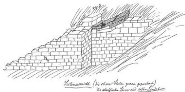
Abb. 10 Augst BL, Theater. Zeichnerische Aufnahme des östlichen Widerlagers der ansteigenden Halbtonne über dem südlichen Teil des südlichen aditus maximus des dritten Theaters. Diese Zeichnung aus dem Anfang dieses Jahrhunderts ist der einzige Nachweis für das Widerlager der ansteigenden Halbtonne auf der Ostseite des Eingangs. Der Befund ist heute verloren.
