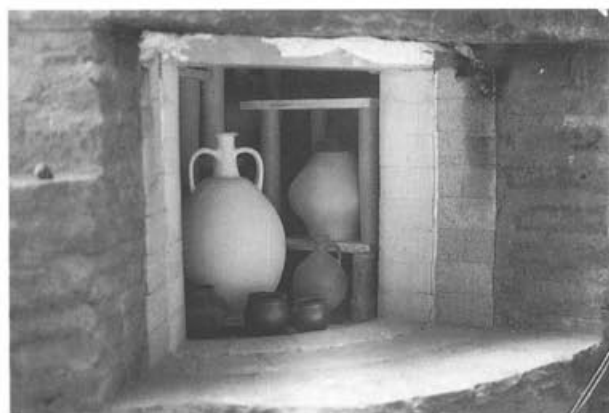
Abb. 6 Der Experimentier-Töpferofen neben der Curia (vgl. auch Abb. 18). Die Bestückung mit Tonware und Brennständen folgt modernen Bedürfnissen. Der Brennvorgang mit Holz vermittelt hingegen einen Eindruck römischer Arbeitstechniken: Bei den bisherigen sechs Testbränden wurden im Durchschnitt innert 10–11 Stunden Innentemperaturen von maximal 1006 bis 1145 °C erreicht. Als Brennholz diente Tannen- und Buchenreisig («Wellen»), abgewechselt von grobem Abbruch- und Scheitholz (Tanne). Der Holzverbrauch betrug regelmässig – bei sorgfältiger Überwachung des Brennvoranges – um die 110 kg (Angaben nach den Brennprotokollen von Roland Gysin).
