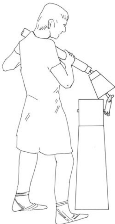
Abb. 7 Das auf einem Holzklotz montierte Presswerkzeug, wie es von einem Handwerker gehandhabt worden sein dürfte.
