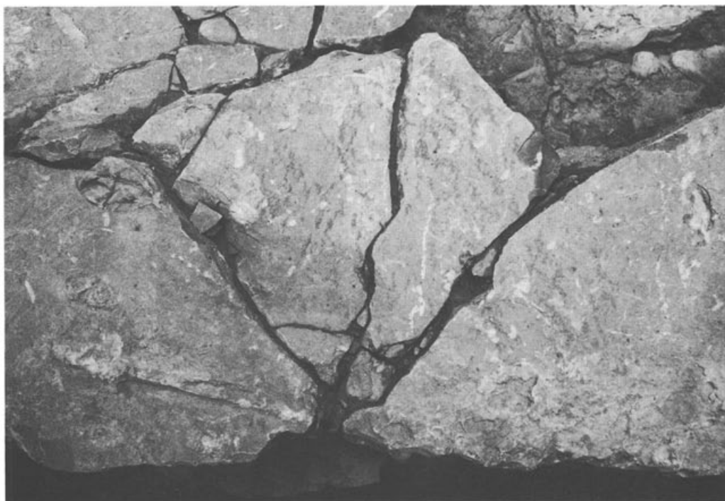
Abb. 7 Kaiseraugst, Parz. 107, U. Brückner. Oberfläche im Mittelstück der Abbauwand: Fächerförmige Risse vom Ansatzpunkt des Hebeleisens.
