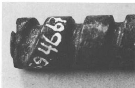
Abb. 3 (Links) Augst, Gewindefragment. Der Pfeil weist auf die kleine Unregelmässigkeit hin, die beim Gewinde-schneiden entstanden ist.
