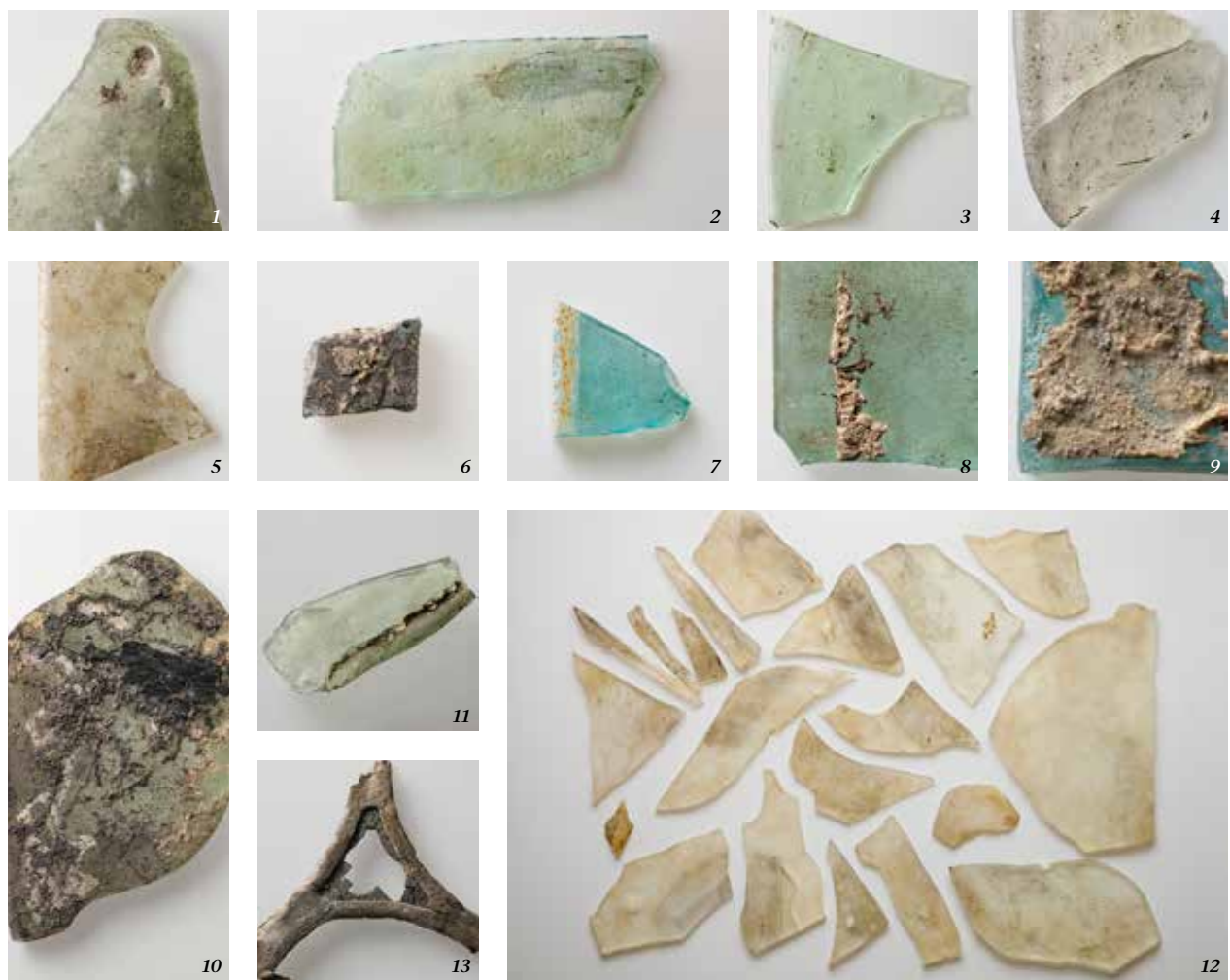
Abb. 285: Augusta Raurica. Eine Übersicht über Fensterglas. 1: Die Ecke zeigt die typischen Spuren, die beim Ziehen der heissen Glasmasse in die Ecken der Form/ Unterlage entstehen. 2: Die Rückseite der Scheiben ist rau. 3–6: Verschiedene Farbtöne, Qualitäten und Jetztzustände von Fensterglas. 7.8: Eine sehr gerade, ab-geschmitten Kante mit einer Mörtelspur vom Befestigen der Scheibe am Gewände sowie eine Mörtelspur entlang des gerundeten Randes. 9: Versinterungen auf der Rückseite. 10: Versinterungen und Holzkohlepartikel. 11: Produktionsfehler, eine Falte. 12: Zersprungenes Fensterglas. 13: Mittelalterliche Verbleiung mit abgekröselten Glaseinsätzen. M. 1:2 (1.8.9: M. 2:1; 4.6.7: M. 1:1). 1: Region 1, Insulae 11/9; 2: Region 2A; 3.5.7: Region 20W; 4: Region 2E; 6: Region 20E/20W; 8.13: Region 1, Insula 8; 9.11: Region 1, Insula 17; 10: Region 1, Insula 9; 12: Region 19A/19B/19C.
