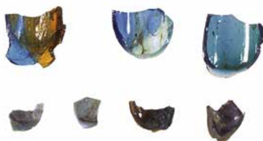
Abb. 4: Avenches/VD. Zweifarbige Abfälle aus der Glaswerkstatt, die chunk-gathering zeigen. Ohne Massstab.
