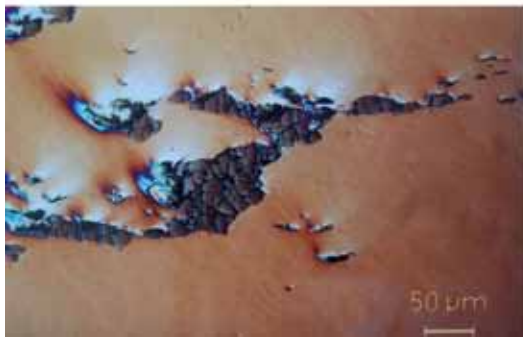
Abb. 274: Gefügeaufnahmen des eisernen Schreibgriffels Vi 102 aus dem Schutthügel von Vindonissa. Genaue Lage siehe Abb. 270.
