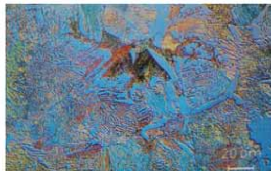
Abb. 272: Gefügeaufnahmen des eisernen Schreibgriffels Vi 102 aus dem Schutthügel von Vindonissa. Genaue Lage siehe Abb. 270.
