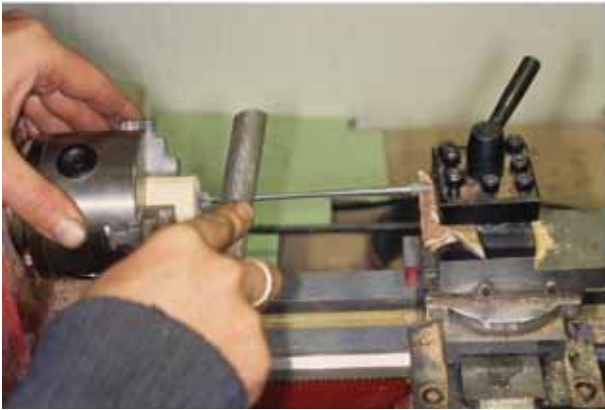
Abb. 244: Werkstatt für Replikat, Holger Ratsdorf: Die Form eines Schreibgriffels wird überarbeitet. Das Hauptwerkzeug ist die Feile und gearbeitet wird an einer dreh- sowie feststellbaren Einspannvorrichtung.
