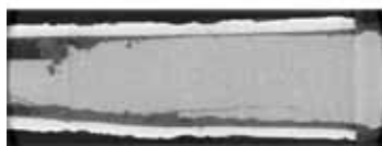
Abb. 295: Vi 100. Axialschnitt 4 ist exzentrisch so ge- legt, dass die Rissfläche möglichst umfassend ange- schnitten wird. Ähnliche Rissverläufe sind am Schreib- spitzen-Stück mehrfach zu erkennen.
