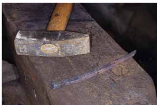
Abb. 242: Schmiede Nieder-Olm/D. Eine dicke Stange aus altem Schmiedeeisen wird für die Herstellung von zwei Schreibgriffeln vorbereitet.
