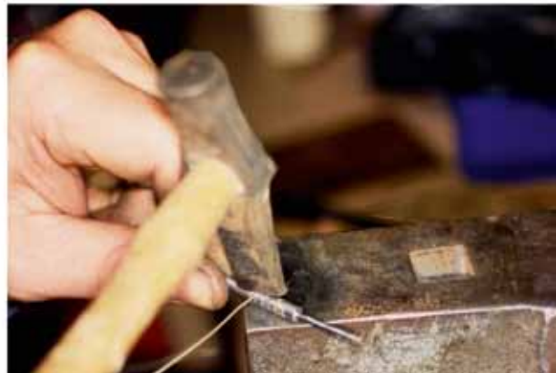
Abb. 246: Werkstatt für Replikat, Holger Ratsdorf: Das Überarbeiten der Rohform des zweiten Griffels (Formgruppe P 56) und das Anbringen der Tauschierungen.
