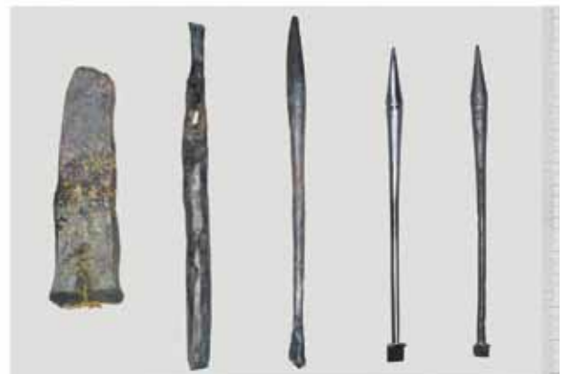
Abb. 245: Werkstatt für Replikate, Holger Ratsdorf: Die für die Formgruppe H 35 typische Dreieckbandverzierung wird an der dicksten Stelle des Schaftes direkt vor der Spitze eingefeilt.
