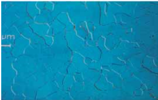
Abb. 273: Gefügeaufnahmen des eisernen Schreibgriffels Vi 102 aus dem Schutthügel von Vindonissa. Genaue Lage siehe Abb. 270.
