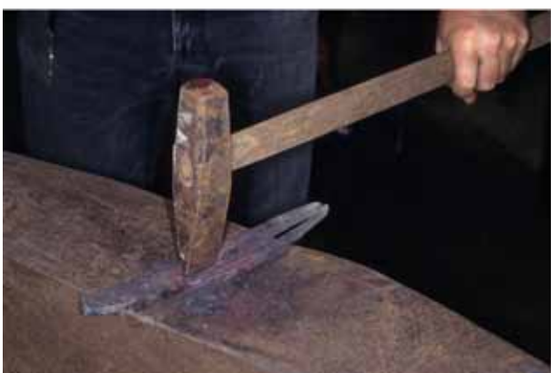
Abb. 242: Schmiede Nieder-Olm/D. Eine dicke Stange aus altem Schmiedeeisen wird für die Herstellung von zwei Schreibgriffeln vorbereitet.
