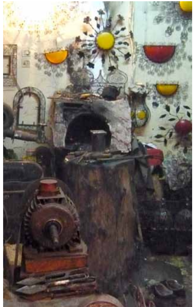
Abb. 248: Souk von Marrakesch/MA. Im Hintergrund ist eine heute nicht mehr genutzte Schmiedesse zu sehen, die den von römischen Abbildungen her bekannten Essen gleicht (das Gebläse – links im Bild – ist allerdings elektrifiziert). Davor steht ein kleiner Amboss für Feinschmiedearbeiten.
