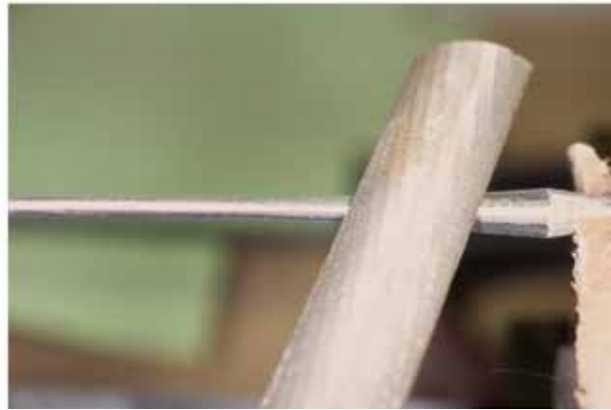
Abb. 244: Werkstatt für Replikat, Holger Ratsdorf: Die Form eines Schreibgriffels wird überarbeitet. Das Hauptwerkzeug ist die Feile und gearbeitet wird an einer dreh- sowie feststellbaren Einspannvorrichtung.
