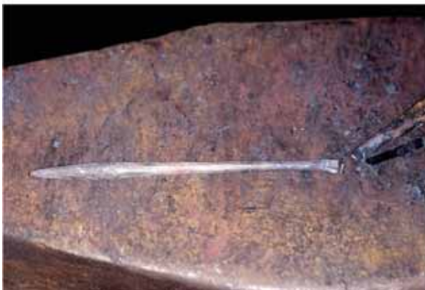
Abb. 243: Schmiede Nieder-Olm/D. Aus einem Schmiedeeisenstück wird die Stilus-Rohform geschmiedet.
