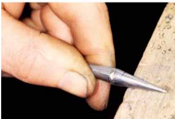
Abb. 245: Werkstatt für Replikate, Holger Ratsdorf: Die für die Formgruppe H 35 typische Dreieckbandverzierung wird an der dicksten Stelle des Schaftes direkt vor der Spitze eingefeilt.
