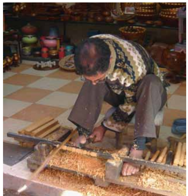
► Abb. 249: Souk von Marrakesch/MA. Ein Holzdrechsler sitzt auf einem niedrigen Stuhl, seine Drechselbank steht auf dem Boden und er führt das Drechslereisen mit der linken Hand und dem rechten Fuss. Nur so ist eine gute Fixierung, die bei dieser Arbeit entscheidend ist, gewährleistet. Mit der rechten Hand bewegt er den Bogen, der das Werkstück antreibt, vor und zurück.
