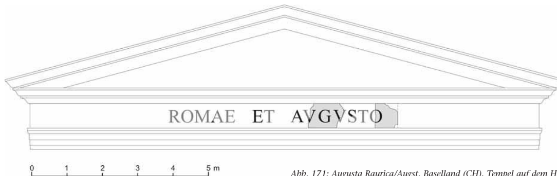
Abb. 171: Augusta Raurica/Augst, Baselland (CH). Tempel auf dem Hauptforum. Rekonstruktionsvorschlag nach P.-A. Schwarz (Profilierung und Giebelneigung hypothetisch). Grau markiert die Friesblöcke mit der Inschrift CIL XIII, 5267; schwarz die aufgefundenen Fragmente von vergoldeten Bronzebuchstaben. Zeichnung M. 1:100.
