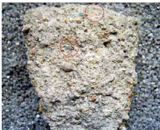
Fig. 300: Augst BL, amphithéâtre-Neun Türme (fouille 1997.055). Deux inclusions de fragments de peinture murale dans le mortier.
