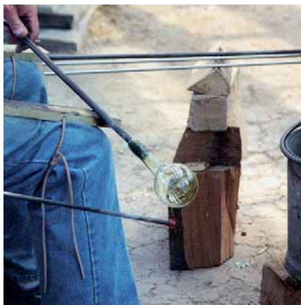
Abb. 124: Quarley/GB. Mark Taylor verziert eine Glasflasche mit einer Fadenauflage. Bei dieser Arbeit brechen immer wieder kleine, stäbchenförmige Glasreste ab, die sich im Laufe der Zeit rund um den Ofen ansammeln (vgl. Abb. 123).
