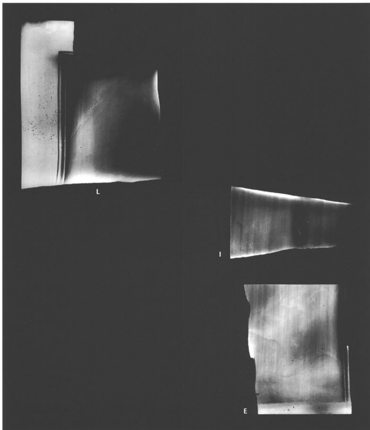
Abb. 50: Augst BL, Insula 20 (Grabung 1966–1967.53). Fragmente E, I und L. Röntgenaufnahmen. Die Fragmente weisen eine homogene und dichte Gussstruktur auf. Nester mit Gussporen finden sich nur vereinzelt (vgl. Abb. 51 und 52). M. 1:5.
