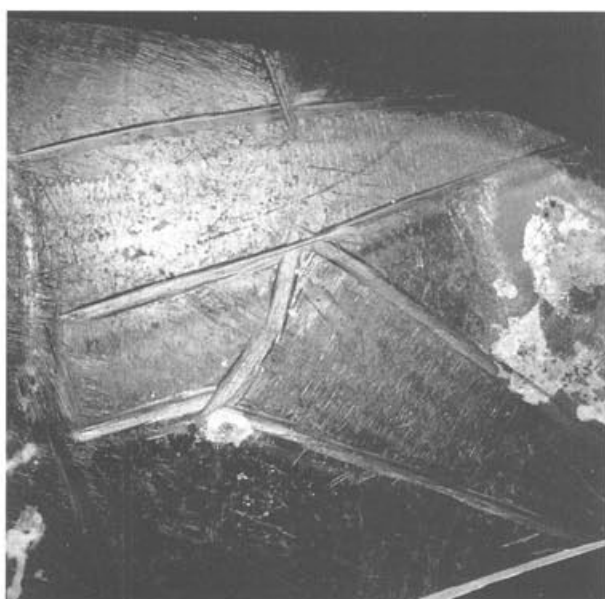
Abb. 1 Die verschiedenen Glasschliffarten. 1 Hohlschliff, 2 Furchenschliff, 3 Umrisslinien mit gerauhten Innenflächen, 4 gerissene Linien. Ohne Massstab.
