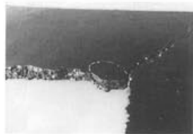
Abb. 119 Pferd II, Partie 10 (Gussteilstück 1), Inv. 1961.2951 (Aussenfläche). Reparatur einer aufgebrochenen Gusspore mit einer Einhämmern. M. 1:1.
