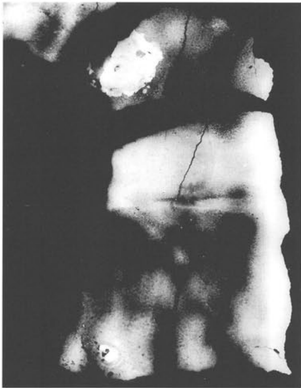
Abb. 359 Pferd II, Partie 25 (Gussteilstück 4), Inv. 1961.3111/2085/2601 (Röntgenfilm). Geschlossene «Schliere» und grosser Reparaturguss im rechten Unterschenkel (vgl. Abb. 361); die wabenartige Struktur im Primärguss könnte durch wiederholte Schläge auf die Wandung entstanden sein. M. 1:2.
