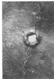
Abb. 65 Pferd II, Partie 12/13 (Gussteilstück 5), Inv. 1961.2140 (Innenfläche). Unverschlossenes Loch eines Distanzhalters unter der Schweifwurzel. M. 1:1.
