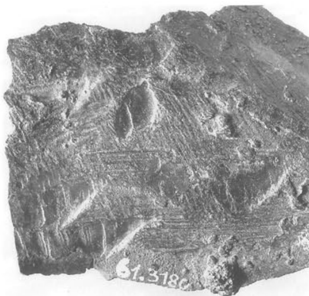
Abb. 283 Pferd II, Partie 1/2 (Gussteilstück 1), Inv. 1961.3180 (Innenfläche). Modellier- und Schaberspurten an der im Wachs verdickten Teilstückkante von Gussteilstück 1, die an das nicht erhaltene Gussteilstück des linken Vorderbeins stiess; Meisselspurten lassen die Abarbeitung der Wandung nach dem Guss erkennen. M. 1:1.
