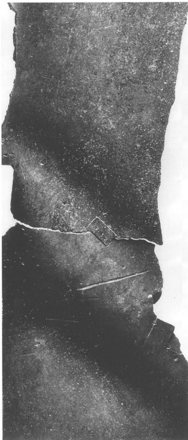
Abb. 202 Pferd I, Partie 9/21/29 (Gussteilstück 8), Inv. 1961.2114/3096 (Aussenfläche). Die im Röntgenfilm von den «Schlieren» begrenzten Gusszonen im Primärguss sind aufgrund der unterschiedlichen Porendichte mit blossen Auge zu erkennen (vgl. Abb. 201). M. 1:1.
