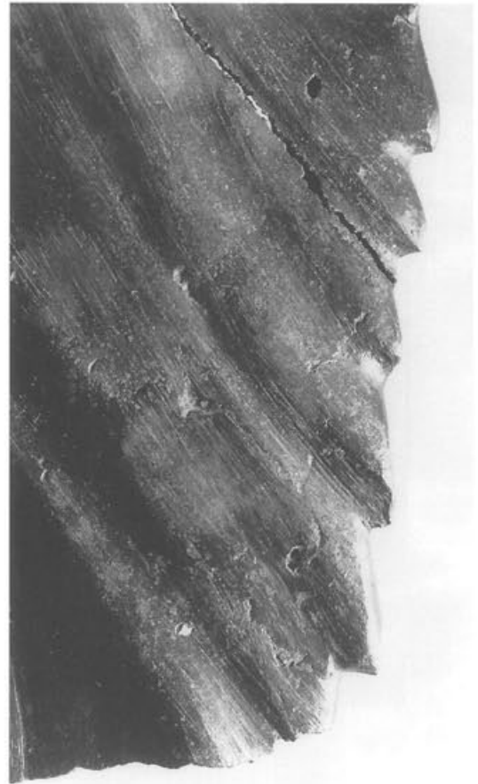
Abb. 327 Pferd II, Partie 31 (Gussteilstück 5), Inv. 1961.2022 (Aussenfläche). Der Reparaturguss an der rechten Seite des Schweißs hebt sich stellenweise mit einer Rille sowie dunkler vom Primärguss ab. M. 1:1.
