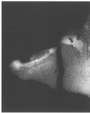
Abb. 70 Pferd II, Partie 37 (Gussteilstück 7), Inv. 1961.2700a.b (Röntgenfilm). Einguss hinter den Nüstern (vgl. Abb. 71). M. 1:1.
