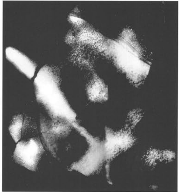
Abb. 250 Pferd I, Partie 22 (Gussteilstück 8), Inv. 1961.14125a.b/3000/2955 (Röntgenfilm). Die beidseitig von «Schlieren» umrahmte horizontale Gussader. M. 1:2.
