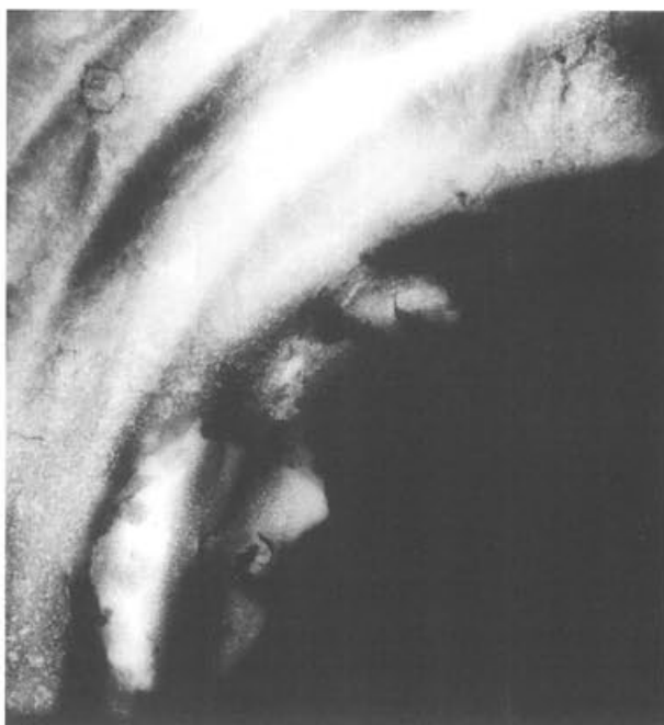
Abb. 282 Wie Abbildung 281, Röntgenfilm. Die «Schliere» markiert die Grenzen zwischen dem im Verbindungsguss zugefügten Material und dem Primärguss; ihr Verlauf ist identisch mit der Grenze der dunklen Verfärbung an der Aussenfläche. M. 1:1.
