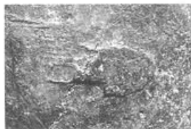
Abb. 296 Pferd II, Partie 6/7 (Gussteilstück 1), Inv. 1961.2025 (Innenfläche). Während der Wachsarbeit aufgespritzter und an der Wandung mitgegossener Wachstropfen. M. 1:1.
