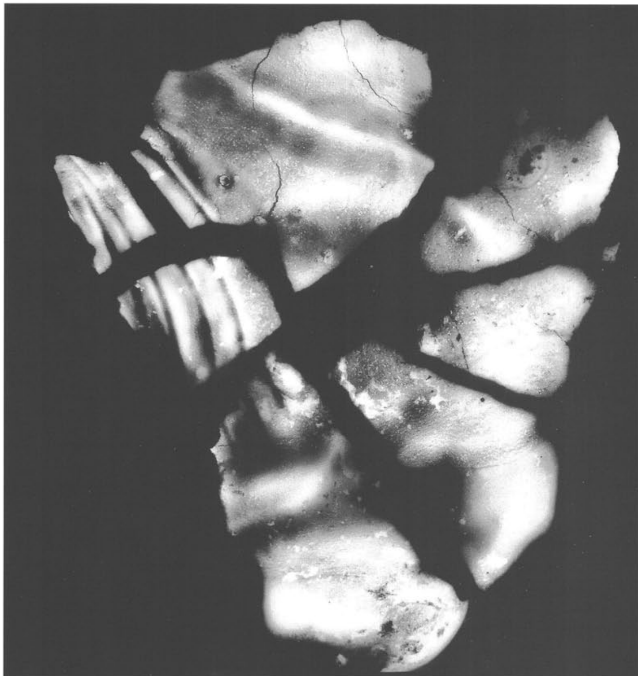
Abb. 306 Pferd II, Partie 10 (Gussteilstück 1), Röntgenfilm. Zwei «Schlieren» im Primärguss des linken Ellbogens; oben links sind ein mit einer Einhämmierung verschlossenes Distanzhalterloch und dicht daneben eine zweite Einhämmierung zu erkennen. M. 1:2.
