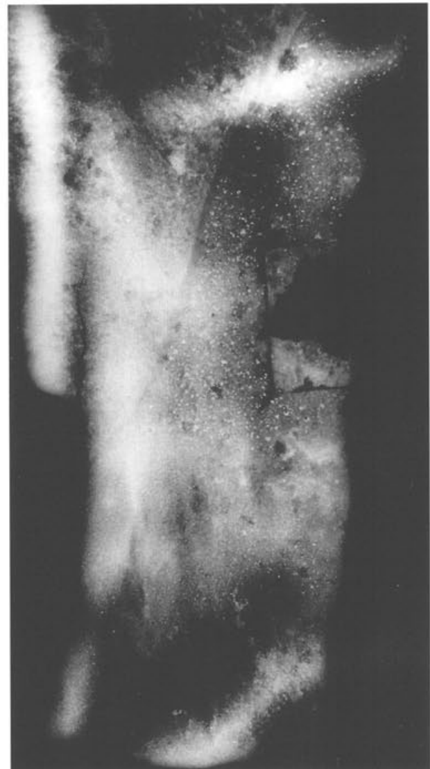
Abb. 185 Pferd I, Partie 4/27 (Gussteilstück 2), Inv. 1961.2831 (Röntgenfilm). «Schlieren» im Primärguss der rechten Hinterbacke. M. 1:1.
