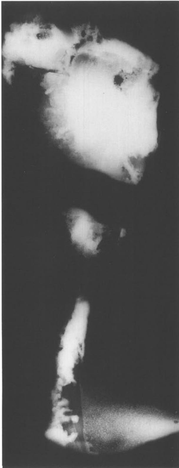
Abb. 313 Pferd II, Partie 12/13, Inv. 1961.2843/2763/2149 (Röntgenfilm). Gussverbindung (Typ 1b) von Gussteilstück 5, Gussteilstück 2 und Gussteilstück 6 (vgl. Abb. 315); die gerade «Schliere» verläuft an der Unterseite der Schweifwurzel innerhalb des ersten Verbindungsgusses zwischen Gussteilstück 5 und Gussteilstück 2 (vgl. Abb. 312 und 314). Oben, an der Stossfuge zwischen Gussteilstück 2 (links), Gussteilstück 5 (rechts) und Gussteilstück 6 (oben), zeichnen sich die mehrfach übereinander angebrachten Verbindungsgüsse hell ab; rechtwinklig dazu steht der Verbindungsguss aus der Gussverbindung von Gussteilstück 6 (oben) mit Gussteilstück 2 (unten). M. 1:1.
