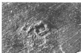
Abb. 107 Pferd II, Partie 6/7 (Gussteilstück 1), Inv. 1961.2798 (Innenfläche). Durch Einhämmern geschlossene Öffnung eines Distanzhalters. M. 1:1.
