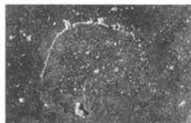
Abb. 104 Pferd I, Partie 4/27 (Gussteilstück 5), Inv. 1961.2075 (Aussenfläche). Von aussen mit einem Flicken verschlossene Öffnung einer Gerüststange, welche zur Fixierung der Gussteilstücke für die Gussverbindung in einem in die gegossene Wandung eingeschnittenen Loch vergossen wurde (vgl. Abb. 105–106). M. 1:1.
