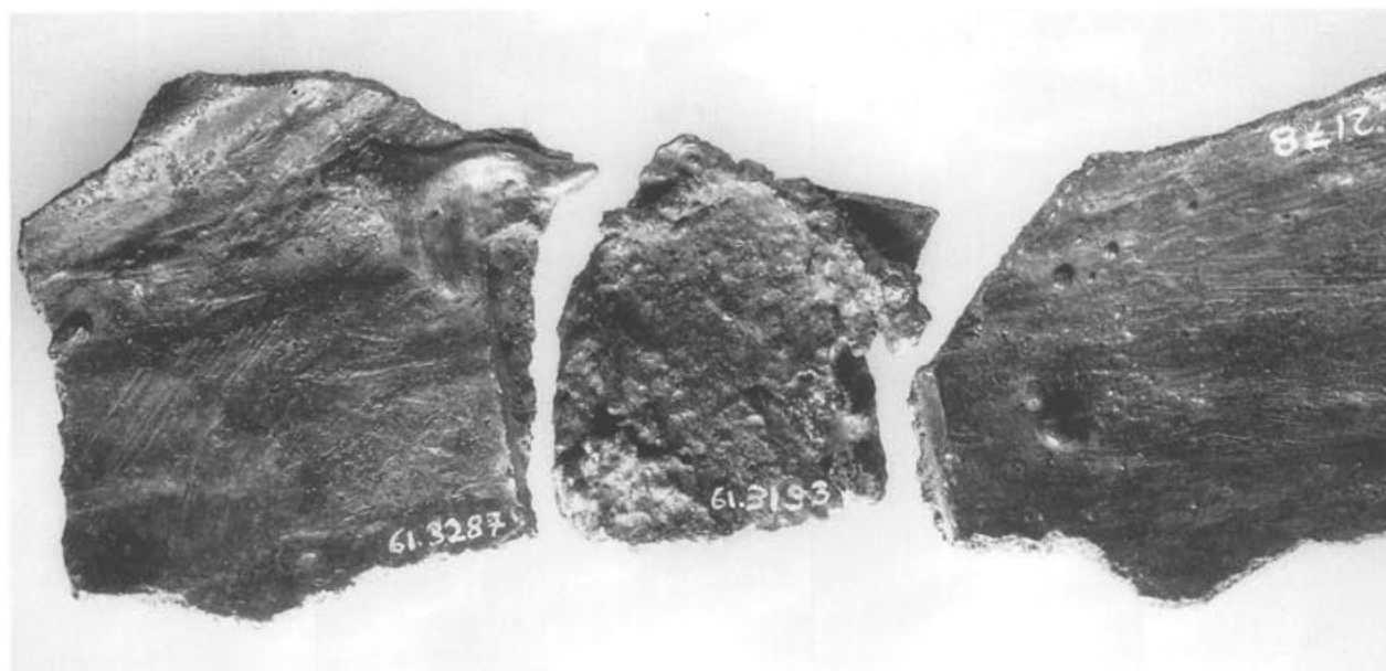
Abb. 112 Pferd II, Partie 12/13 (Gussteilstück 5), Inv. 1961.3287/3193/2178 (Innenfläche). Reparatur durch Überfangguss vom in das WachsmodeLL eingeschnittenen «Fenster» für die Entlüftung des Gusskerns (vgl. Abb. 128); in der Mitte des inwendig aufgetragenen Gusses befindet sich der Abdruck von einem in die noch flüssige Bronze aufgedrückten Werkzeug. M. 1:1.
