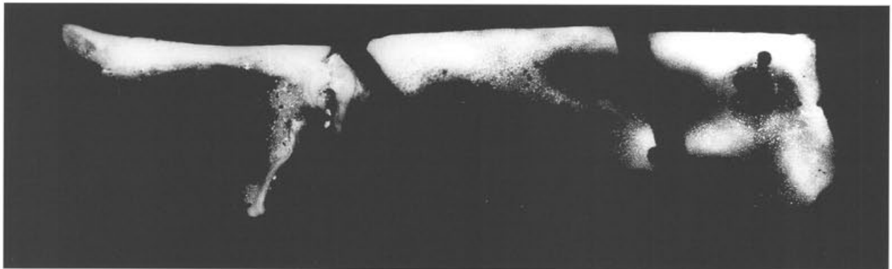
Abb. 216 Pferd I, Partie 16 (Röntgenfilm). Punktguss aus der Gussverbindung (Typ 2a) von Gussteilstück 9 (links) und Gussteilstück 8 (rechts); dort befindet sich die mit einem Flicken verschlossene, quadratische Öffnung von einer Gerüststange, welche zur Fixierung der Gussteilstücke für die Gussverbindung in einem in die gegossene Wandung eingeschnittenen Loch vergossen wurde (vgl. Abb. 220–221). M. 1:2.
