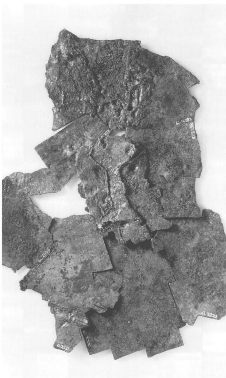
Abb. 94 Pferd I, Partie 30 (Innenfläche). Gussverbindung (Typ 2b) von Gussteilstück 8 (rechts) mit Gussteilstück 1 (links unten) und Gussteilstück 13 (links); vgl. Abb. 95. Nahezu die gesamte Partie ist mit Weichlot vom Verlöten der grossen Flicken bedeckt (vgl. Abb. 259). M. 1:2.
