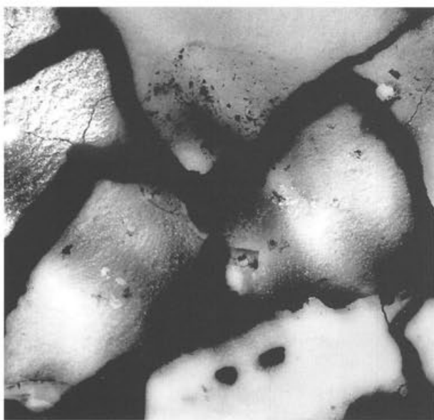
Abb. 298 Pferd II, Partie 6/7, Inv. 1961.2137/2785/2030/3235 (Röntgenfilm). Oberhalb der Gussverbindung von Gussteilstück 1 und Gussteilstück 2 befindliche geschlossene «Schliere» im Primärguss; darunter verläuft die Gussverbindung (Typ 1a) von Gussteilstück 1 und Gussteilstück 2 quer durch die Mitte des Rumpfes (vgl. Abb. 82). M. 1:2.
