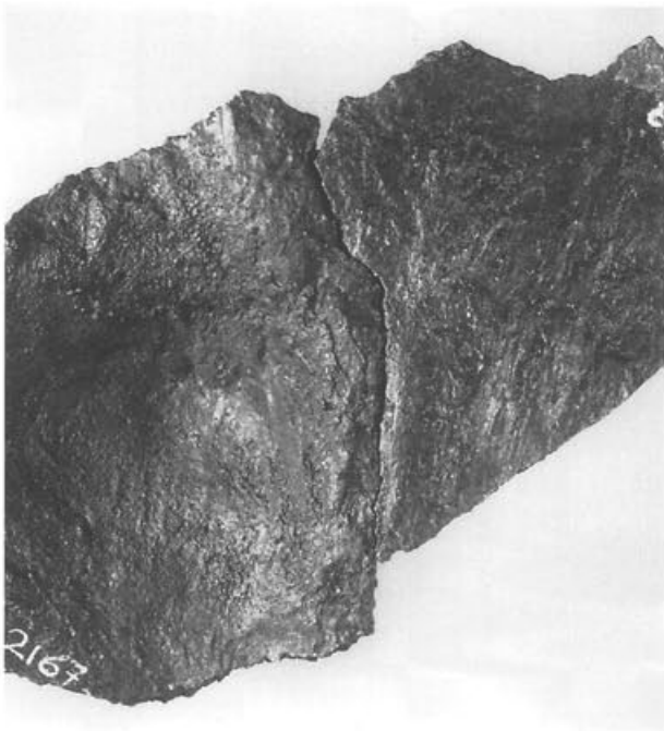
Abb. 58 Pferd I, Partie 11 (Gussteilstück 2), Inv. 1961.2167/3263 (Innenfläche). Spuren von der Wachsarbeit mit einem grobporstigen Pinsel oder Quast im Bereich des Afters. M. 1:1.
