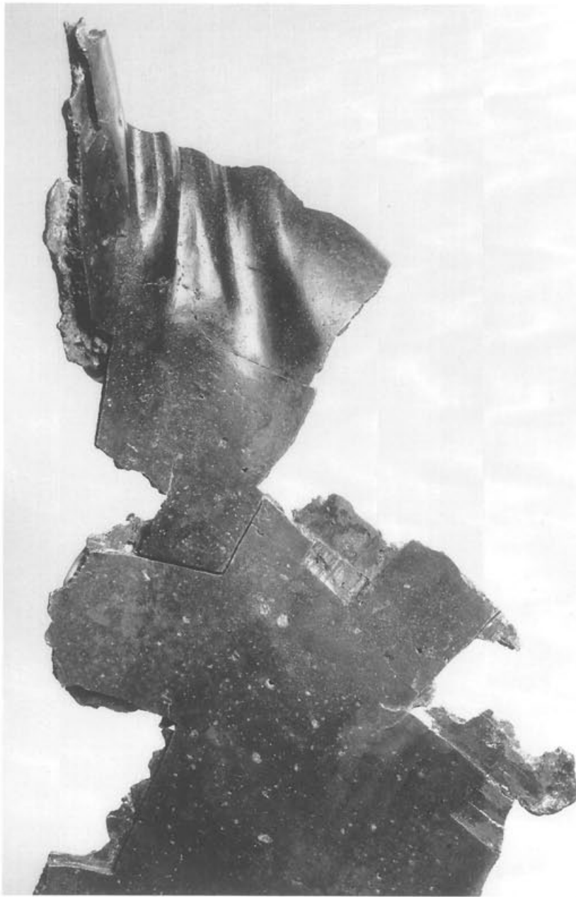
Abb. 205 Wie Abbildung 204, Aussenfläche. Die grossen, polygonalen Flicken verschliessen sowohl die Fuge zwischen den Punktgüssen wie auch Fehlstellen innerhalb der Punktgüsse selbst. M. 1:1.
