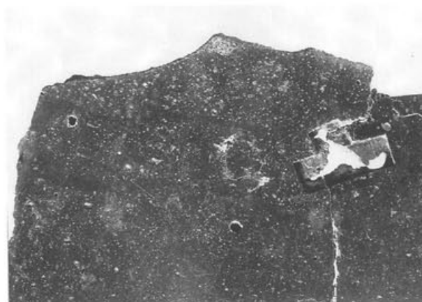
Abb. 234 Wie Abbildung 233, Aussenfläche. Der Punktguss setzt sich dunkel vom Primärguss ab, wobei die Grenze mit der im Röntgenfilm sichtbaren «Schliere» identisch ist (vgl. Abb. 232–233). M. 1:1.
