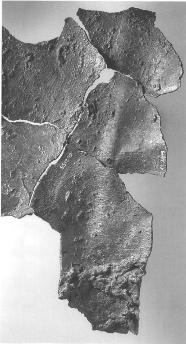
Abb. 345 Pferd II, Partie 23 (Gussteilstücke 2.3), Inv. 1961.2155/3079/2012/2013/2096 (Innenfläche). Die senkrechte Wachsplattennaht in Gussteilstück 2 an der Vorderseite des linken Hinterbeins; die von links unten schräg auftreffende zweite Naht ergab sich durch eine in die Wölbung eingefügte dreieckige Wachsplatte. Beide Nähte wurden mit flüssig aufgespritztem Wachs verschlossen. Unten verläuft die Gussverbindung (Typ 1b) von Gussteilstück 2 und Gussteilstück 3 (vgl. Abb. 84–85) M. 1:2.
