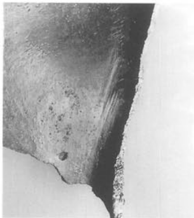
Abb. 125 Pferd II, Partie 23 (Gussteilstück 2), Inv. 1961.2959 (Aussenfläche). Mit einem Polierstahl geglättete Feilspuren in der linken Leiste (vgl. Abb. 124). M. 1:1.
