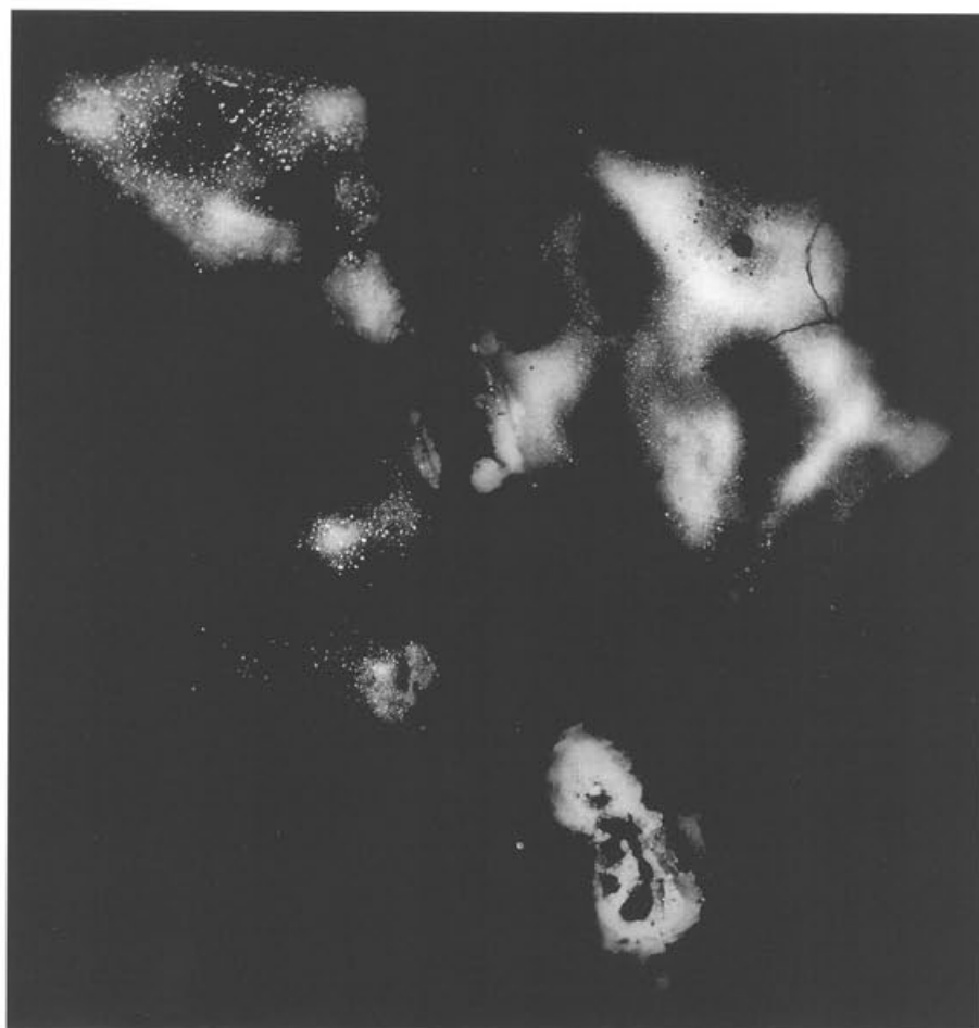
Abb. 225 Pferd I, Partie 17, Inv. 1961.2129/2956/2778/ 3047 (Röntgenfilm). Die beiden Punktgüsse aus der Gussverbindung (Typ 2a) von Gussteilstück 8 (links) und Gussteilstück 10 (rechts). Vgl. Abb. 227– 228. M. 1:2.
