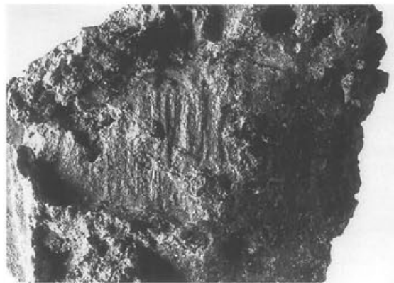
Abb. 87 Wie Abbildung 86, Innenfläche. Trapezförmiger Abdruck auf dem letzten Verbindungsguss von Gussteilstück 6, Gussteilstück 2 und Gussteilstück 7 (vgl. Abb. 315). M. 1:1.
