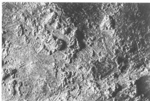
Abb. 279 Pferd II, Partie 1/2 (Gussteilstück 1), Inv. 1961.2957 (Innenfläche). Krümel mit Schaberspur, welche von der Abarbeitung der Wachswandung stammen und als Überstände mitgegossen wurden. M. 1:1.
