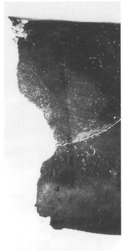
Abb. 314 Pferd II, Partie 12/13 (Gussteilstück 2), Inv. 1961.2843/2833 (Aussenfläche). Die Kante der sich dunkel abzeichnenden Gussverbindung an der Unterseite der Schweifwurzel verläuft identisch mit der «Schliere» im ersten Verbindungsguss (vgl. Abb. 313). M. 1:1.
