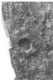
Abb. 108 Pferd I, Partie 9/21/29 (Gussteilstück 8), Inv. 1961.3102 (Innenfläche). Mit Flickern geschlossenes, rund ausgeschlagenes Loch eines Distanzhalters. M. 1:1.
