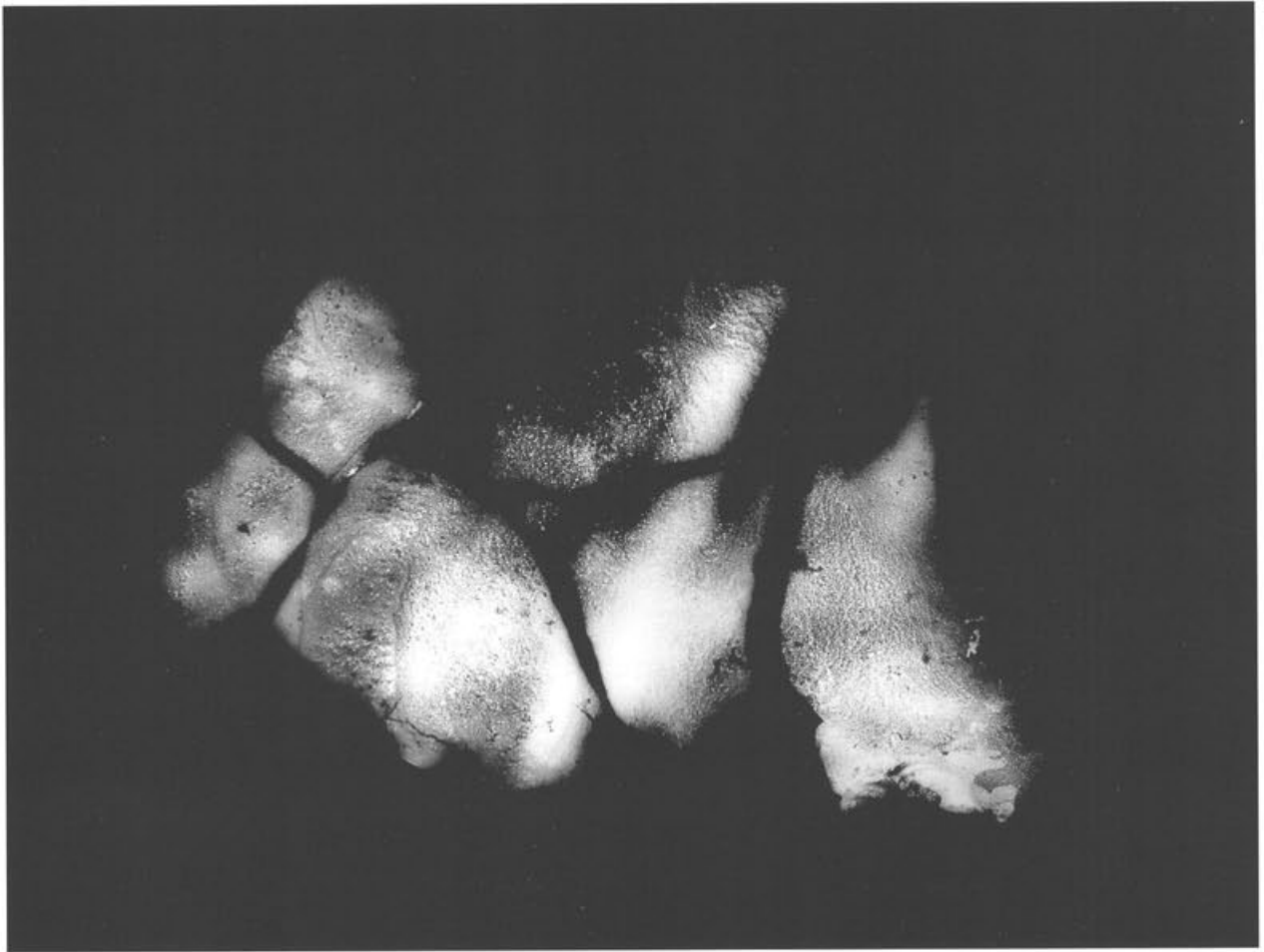
Abb. 366 Pferd II, Partie 26 (Gussteilstück 6), Inv. 1961.2561/2571/3043/2230/2335/14044a.b/3271 (Röntgenfilm). Der von «Schlieren» durchzogene Primärguss und der Rest aus der Gussverbindung (Typ 1a) mit Gussteilstück 2 aus zwei über Eck gesetzten Einzelgüssen (vgl. Abb. 367–368). M. 1:3.
