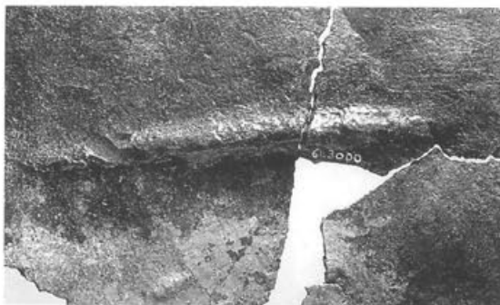
Abb. 249 Pferd I, Partie 22 (Gussteilstück 8), Inv. 1961.14125a.b/3000 (Innenfläche). Horizontale «Gussader». M. 1:2.
