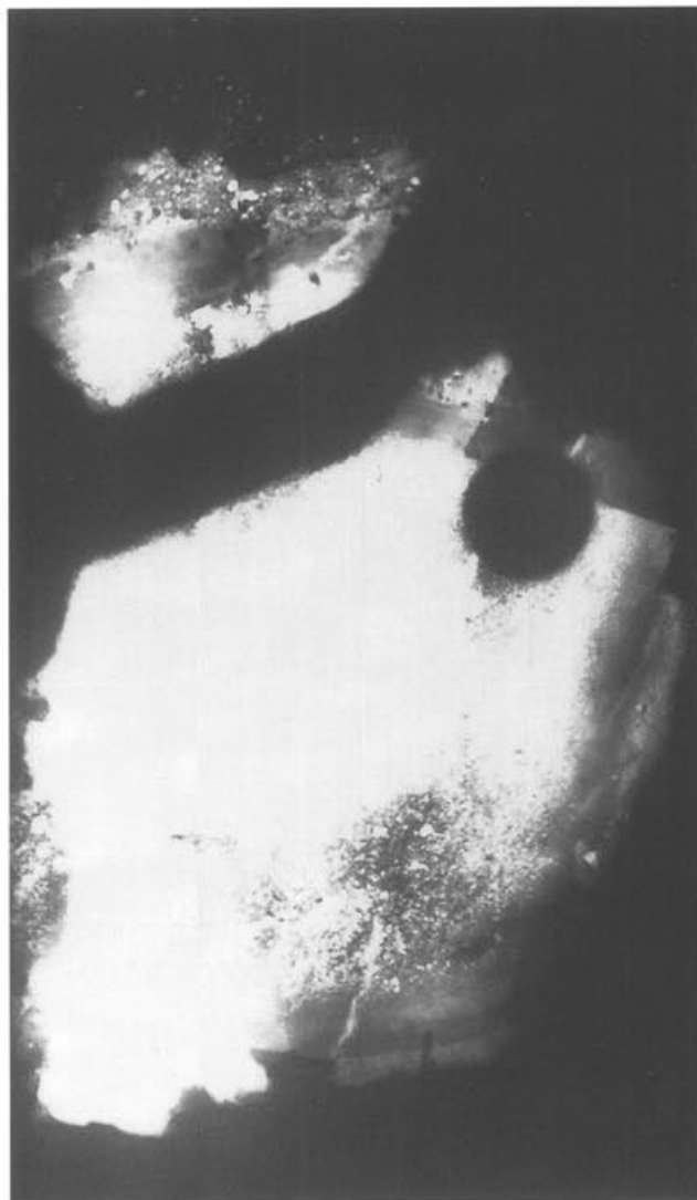
Abb. 79 Pferd I, Partie 4/27, Inv. 1961.2743/14108 (Röntgenfilm). «Schliere» in der Gussverbindung (Typ 3) von Gussteilstück 1, Gussteilstück 2 und Gussteilstück 5 an der Vorderseite des rechten Unterschenkels (vgl. Abb. 78). M. leicht unter Originalgrösse.
