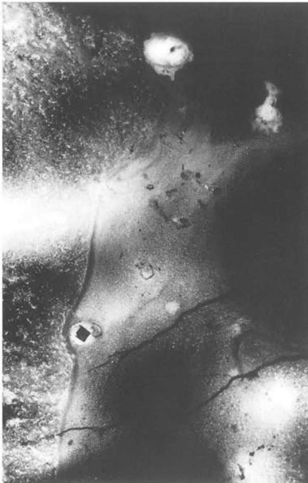
Abb. 77 Pferd II, Partie 15 (Gussteilstück 1), Inv. 1961.14131 (Röntgenfilm, Ausschnitt von Abb. 332). Senkrechte «Schliere» im Primärguss an der linken Schulter. M. 1:1.
