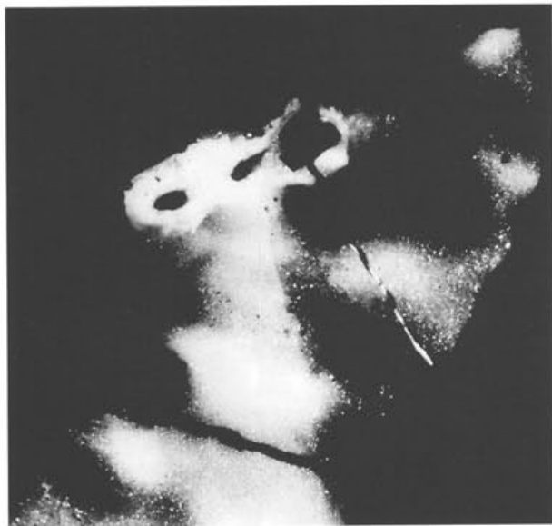
Abb. 232 Pferd I, Partie 18 (Gussteilstück 11), Inv. 1961.2525/2802/2121 (Röntgenfilm). Eine rechtwinklig zur Teilstückkante stehende «Schliere» im Primärguss trennt zwei unterschiedliche Gusszonen. Obwohl die Wandung gleichmässig dick ist, erscheinen die Gusszonen im Röntgenfilm unterschiedlich geschwärzt. Oben befindet sich der obere der drei erhaltenen Punktgüsse aus der Gussverbindung (Typ 2a) mit Gussteilstück 13 (vgl. Abb. 233–234). M. 1:2.
