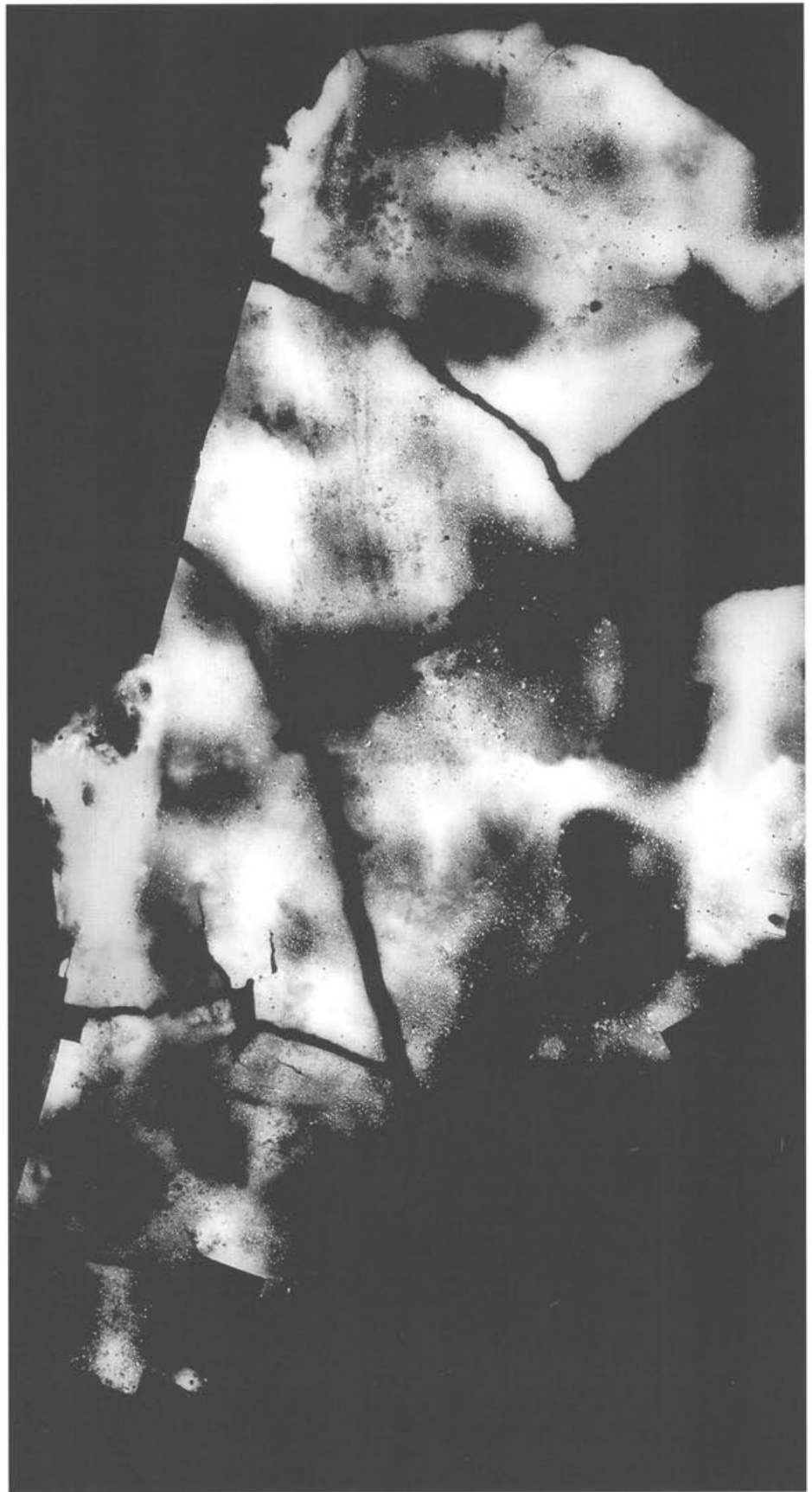
Abb. 241 Pferd I, Partie 19 (Gussteilstück 11), Röntgenfilm. Die beiden unteren Punktgüsse aus der Gussverbindung (Typ 2a) mit Gussteilstück 13 (vgl. Abb. 240; 242–243). Rechts unten treffen zwei unterschiedliche Gusszonen aufeinander, die sich aufgrund der Anzahl, Verteilung und Grösse der Bleieinschlüsse unterscheiden. M. 1:2.
