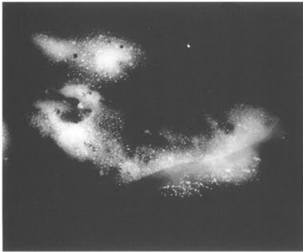
Abb. 76 Pferd I, Partie 4/27 (Gussteilstück 1), Inv. 1961.2214 (Röntgenfilm). «Schliere» im Primärguss in der linken Leiste. M. 1:1.
