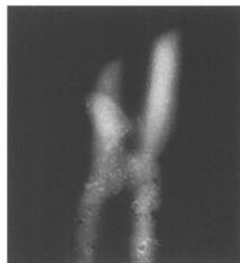
Abb. 75 Wie Abbildung 74, Röntgenfilm. Ringförmige «Schliere» innerhalb des abgeschroteten Eingusses. M. 1:1.
