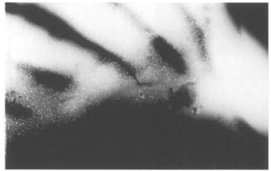
Abb. 72 Pferd I, Partie 4/27 (Gussteilstück 1), Inv. 1961.2203/2506 (Röntgenfilm). Einguss der mittleren Gussader vor dem Schlauch. M. 1:1.
