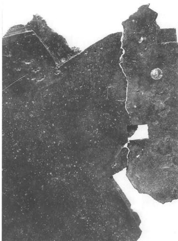
Abb. 171 Wie Abbildung 170, Aussenfläche. Rechts die offene Teilstückkante von Gussteilstück 14; oben schloss ein grosser Flicker die offene Stelle im Kaltguss. Beim hellen Fleck auf dem linken sekundär verbrannten Fragment handelt es sich um nachträglich aufgetropftes Weichlot (Zinn). M. 1:1.
