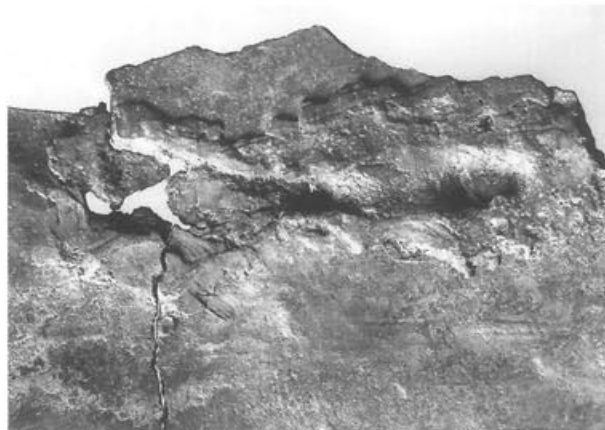
Abb. 233 Pferd I, Partie 18 (Gussteilstück 11), Inv. 1961.2802/2525 (Innenfläche). Der obere von drei erhaltenen Punktgüssen aus der Gussverbindung (Typ 2a) mit Gussteilstück 13; vgl. Abb. 232 und 234. M. 1:1.
