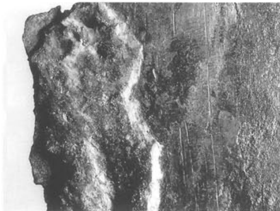
Abb. 103 Pferd I, Partie 4/27 (Gussteilstück 3), Inv. 1961.2898 (Innenfläche). Schaber- und Feilspuren vom Glätten der Wandung zur Vorbereitung des Punktgusses an der Rückseite des linken Unterschenkels. M. 1:1.
