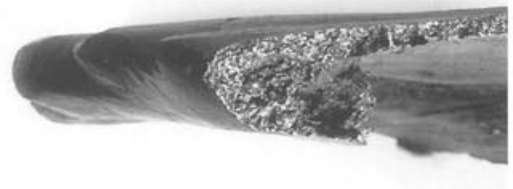
Abb. 328 Pferd II, Partie 31 (Gussteilstück 5), Inv. 1961.2022 (Aufsicht). In der Bruchfläche an der rechten Schweißkante zeichnen sich der Primärguss und der innen anstehende Reparaturguss als zwei Schichten ab. M. 1:1.
