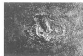
Abb. 290 Pferd II, Partie 5 (Gussteilstück 2), Inv. 1961.3253a (Innenfläche). Einkorrodierter Rest eines eisernen Distanzhalters. M. 1:1.
