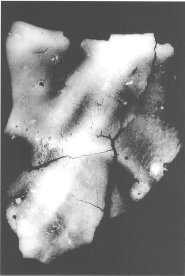
Abb. 275 Pferd II, Partie 1/2 (Gussteilstück 1), Inv. 1961.2894 (Röntgenfilm). Fragment von der Teilstückkante am Hals mit zwei Distanzhalterlöchern (links) und zwei Reparaturgüssen (rechts); die wabenartige Struktur im Primärguss an der rechten Seite des Fragmentes könnte durch wiederholte Schläge auf die Wandung entstanden sein. M. 1:2.
