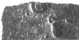
Abb. 350 Pferd II, Partie 23 (Gussteilstück 2), Inv. 1961.14129 (Innenfläche). Durch Einhämmern geschlossenes Distanzhalterloch; seine Kante, die beim Einstecken des Stiftes von aussen in die Wachswandung innen wulstig aufstand und in dieser Form gegossen wurde, ist dabei gestaucht worden. M. 1:1.
