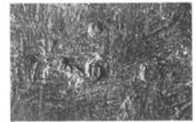
Abb. 381 Pferd II, Partie 37 (Gussteilstück 7), Inv. 1961.2515 (Innenfläche). Krümeln mit Schaberspuren, welche von der Abarbeitung der Wachswandung stammen und als Überstände mitgegossen wurden. M. 1:1.
