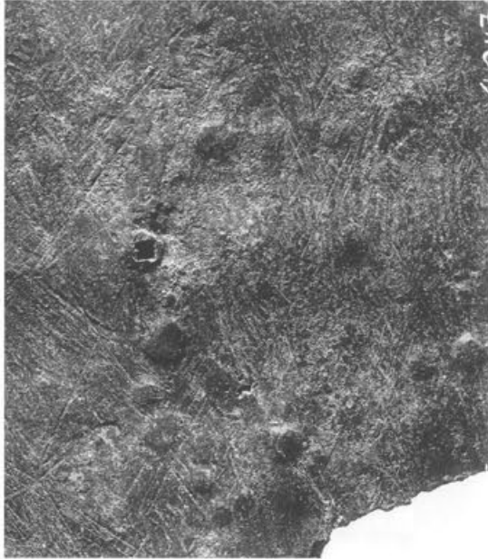
Abb. 342 Pferd II, Partie 20 (Gussteilstück 1), Inv. 1961.2117 (Innenfläche). Durch das Einschlagen der Bronzestückchen (Reparatur durch Einhämmern) von der Aussen- seite her wölbte sich die Wandung nach innen aus. M. 1:1.
