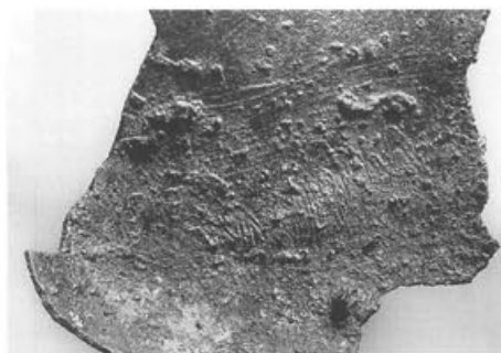
Abb. 303 Pferd II, Partie 10 (Gussteilstück 1), Inv. 1961.14123 (Innenfläche). In der Wölbung des linken Ellbogens verlaufende Wachsplattennaht. M. 1:2.
