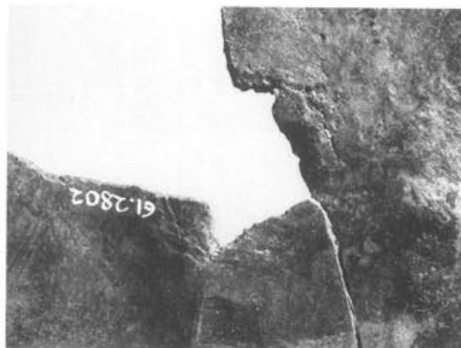
Abb. 231 Pferd I, Partie 18 (Gussteilstück 11), Inv. 1961.2121/2802 (Innenfläche). Viereckiger Abdruck von einer Gerüststange des Wachsmodells in der linken Weiche. M. 1:1.
