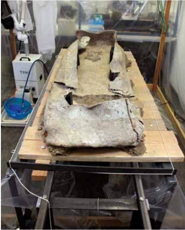
Abb. 33: Augst BL, Rheinstrasse (Grabung 2016.055). Bleisarg (Grab 13). Montagehilfe und Gestell nach der Entfernung des rechten Längskanthaltes und der endgültigen Ausrichtung (Westseite Sarg).
