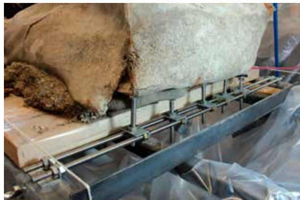
Abb. 35: Augst BL, Rheinstrasse (Grabung 2016.055). Bleisarg (Grab 13). Eingebaute Messtraverse mit fixierten Auflagepunkten (Ostseite Sarg).
