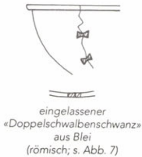
Abb. 5 (unten) Drei Prinzipien von Keramikflicken. Ohne Massstab:
