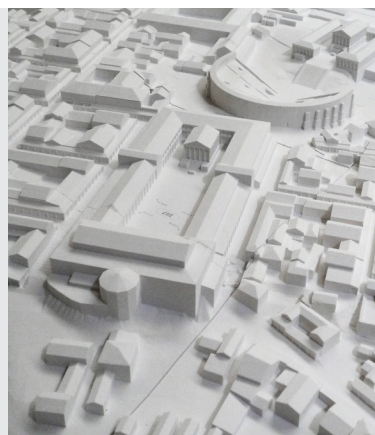
Arbeiten der Firma Visual-Data-Systems in Arlesheim. Links: Zwischenstand beim Absaugen einer gedruckten 3D-Platte mit Quartieren der Oberstadt.
