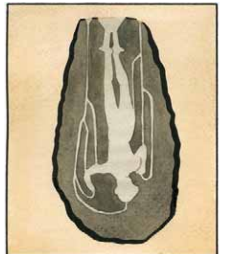
Coupe d'un moule en argile
